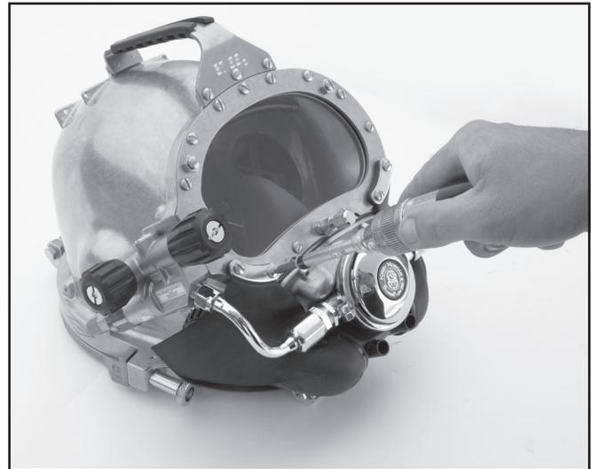
*Retire los tornillos que sujetan el marco de retención.*
