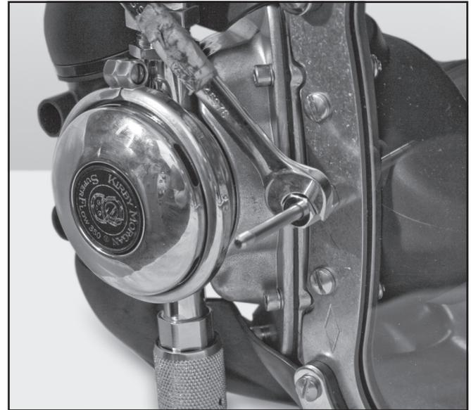
*No ajuste excesivamente la tuerca de presión del bloqueador nasal; esto impedirá que la varilla se deslice fácilmente.*
