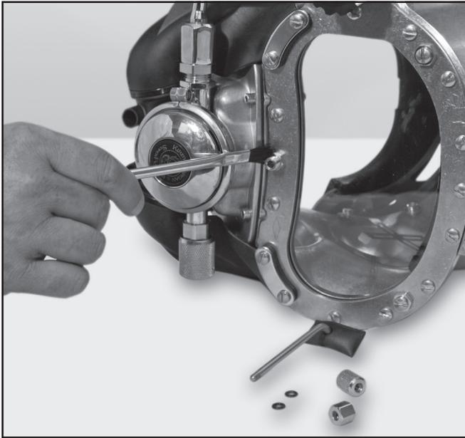
Las roscas de la guía del bloqueador nasal deben lubricarse periódicamente. Aquí se pueden ver todas las piezas del bloqueador nasal (con la excepción de la junta tórica que sella la cara interna del marco de retención del visor).
