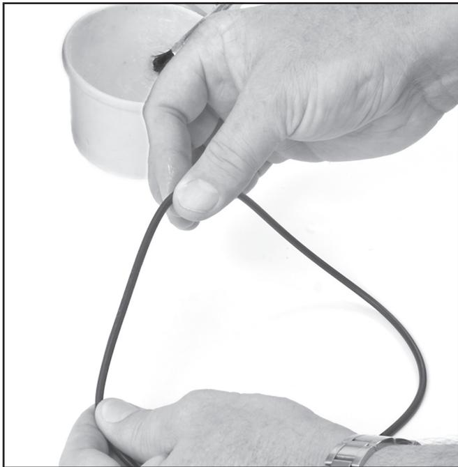
*Aplique un poco de lubricante a la junta tórica del visor antes de instalarla en la ranura correspondiente.*
