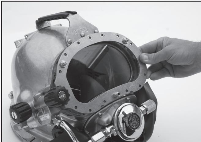
*Coloque el marco de retención del visor en el armazón del casco o el marco de la máscara.*
