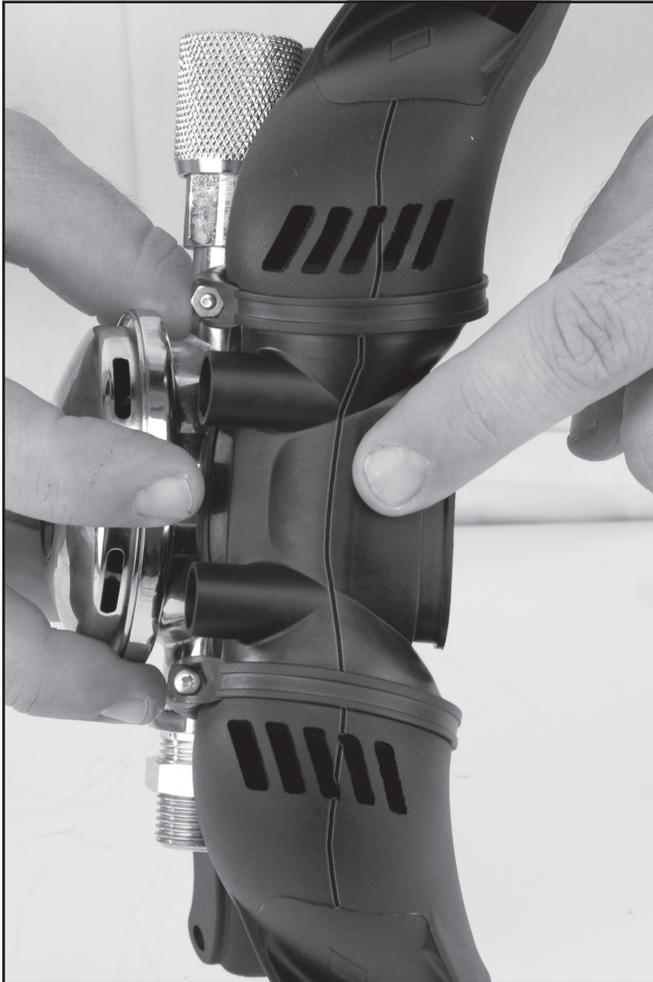
*Observe la posición correcta de la línea de moldeado que recorre las bigoterías y el cuerpo principal del sistema de escape.*
