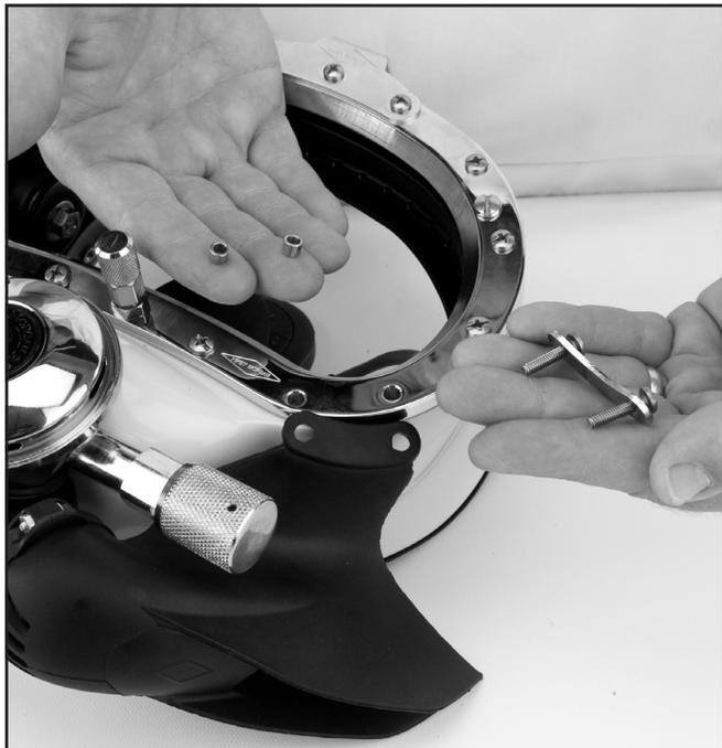
*Recuerde volver a colocar los espaciadores antes de conectar las placas reniformes a la máscara.*
