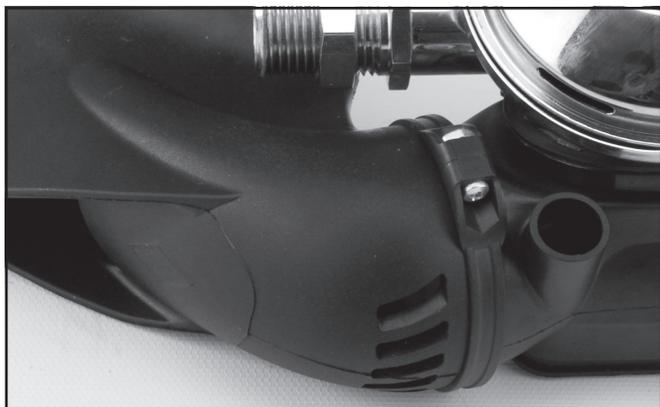
*Para poder acceder a la válvula de escape de cada bigotería, primero debe quitar las dos abrazaderas que sujetan las bigoterías al cuerpo principal del sistema de escape.*
