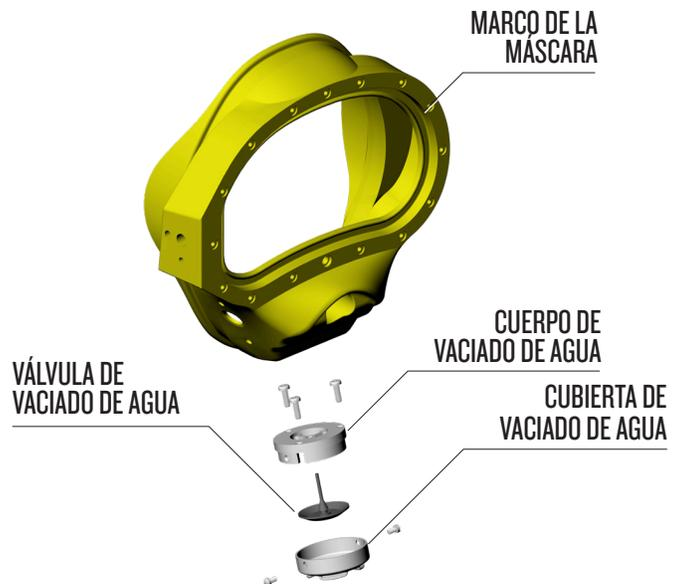
*Conjunto de cuerpo, válvula y cubierta de vaciado de agua de la máscara KMB 18. En la máscara KMB 28, el cuerpo está incorporado al molde del marco.*
