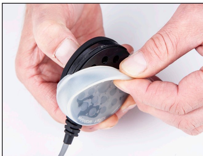
Retire la tapa de caucho del auricular.
