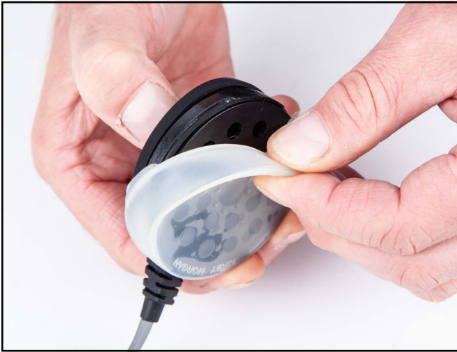
Retire la tapa de caucho del auricular.
