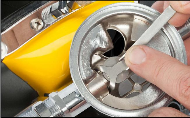
*Use el extremo de disco de la llave de ajuste del regulador KMDSI para doblar la palanca hacia abajo.*
