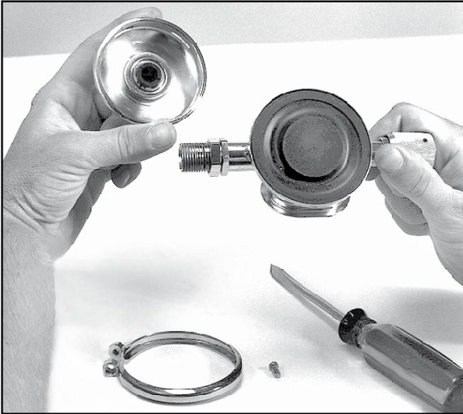
*Retire la abrazadera de la cubierta del regulador.*
