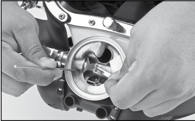
*Inserte el sujetador de la válvula de entrada en el orificio de compensación del tubo de entrada.*
