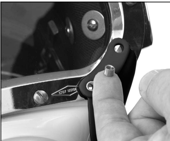
*No se olvide de colocar los espaciadores de las bigoterías cuando vuelva a instalar las bigoterías.*
