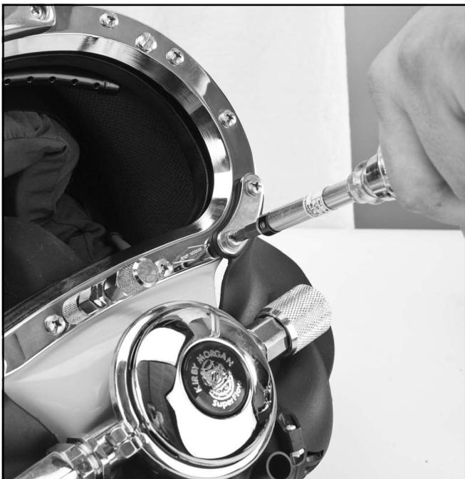
*Retire las bigoteras del casco.*
