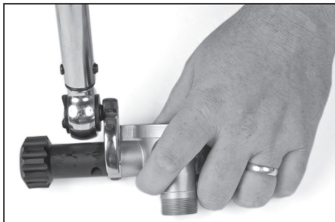
Desenrosque la tuerca de presión del cuerpo del regulador.
