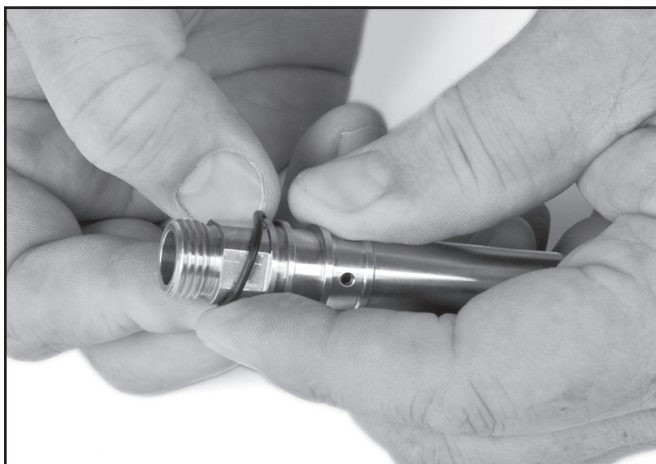
Instale la junta tórica en el tubo principal.
