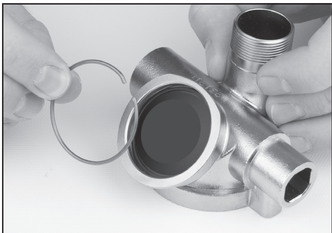
Instale el anillo de sujeción.
