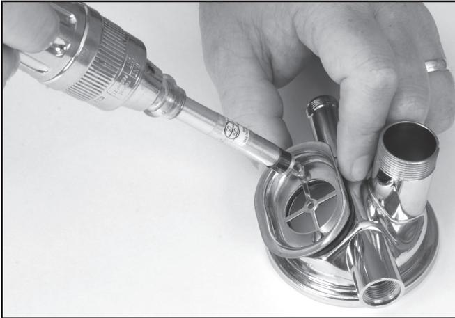
*Los tornillos que sujetan la brida al cuerpo del regulador deben ajustarse al par de apriete correcto, que se especifica en el módulo “Apéndice”, página APNDX-19, sección “Pares de apriete”.*
