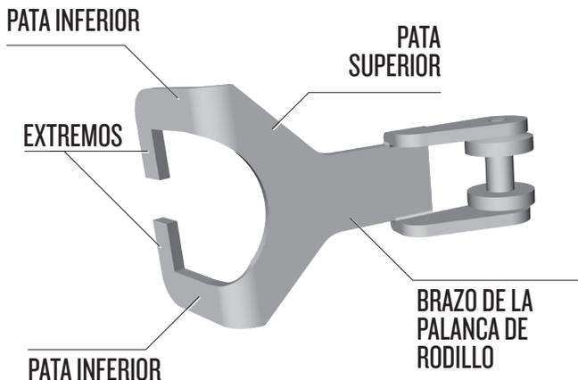
Tenga en cuenta que las patas de la palanca de rodillo deben estar correctamente alineadas y en el mismo plano para que la palanca funcione adecuadamente.
