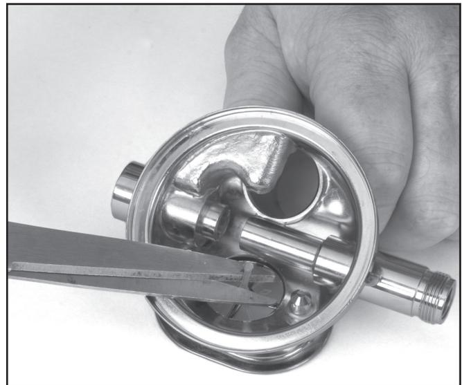
*Recorte el vástago de la válvula de escape que se introduce al cuerpo del regulador.*
