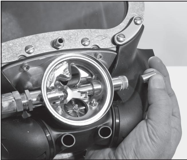
2) Afloje la tuerca; luego, gire la perilla de ajuste en sentido antihorario hasta que la perilla y la varilla de ajuste se suelten.
