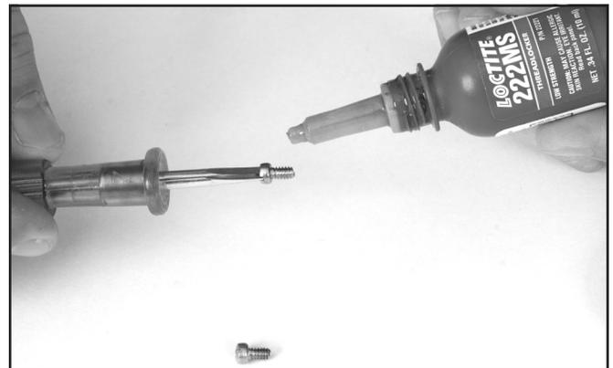
*Asegúrese de usar fijador de roscas Loctite® para instalar los tornillos en el cuerpo del regulador.*
