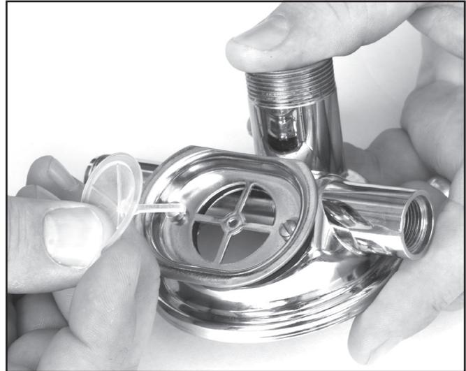
*La válvula de escape se debe instalar en la parte exterior de la brida.*
