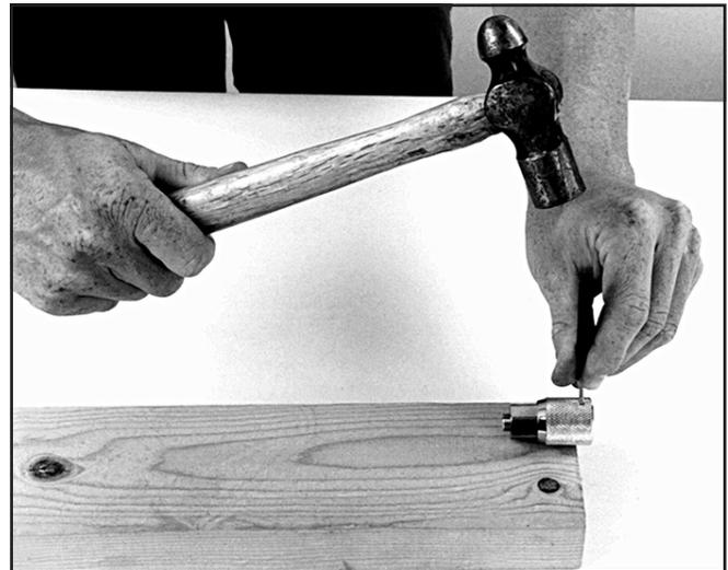
*Instale el pasador de sujeción en la perilla de ajuste.*
