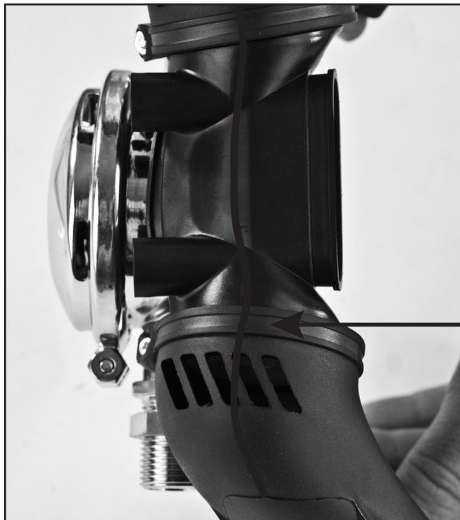
*Las bigoterías derecha e izquierda se deben alinear con el cuerpo principal del sistema de escape, de modo que las líneas de moldeado queden alineadas (a excepción del casco SL 27, donde las líneas de moldeado en la parte inferior de las bigoterías deben quedar 5/16" [7,93 mm] detrás de la línea de moldeado del cuerpo principal). También puede hacer marcas en las bigoterías con un rotulador.*
