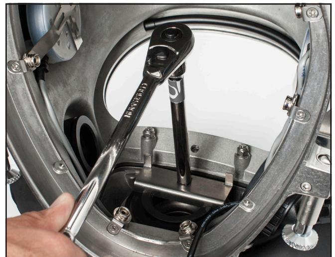
*Ajuste la tuerca de montaje del regulador. Encontrará el par de apriete correcto en el módulo "Apéndice", página APNDX-19, sección "Pares de apriete". Use una llave dinámico para garantizar el ajuste correcto.*
