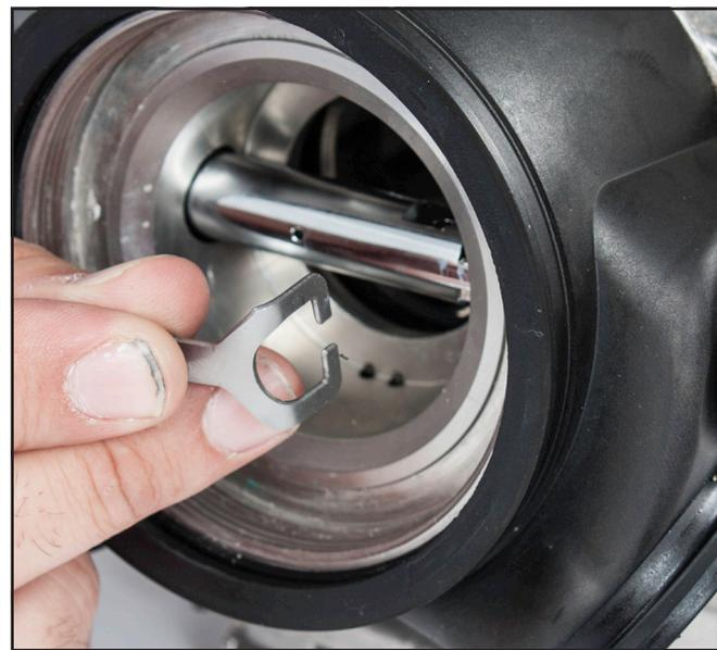
*Antes de instalar la palanca de rodillo, debe colocar la herradura.*
