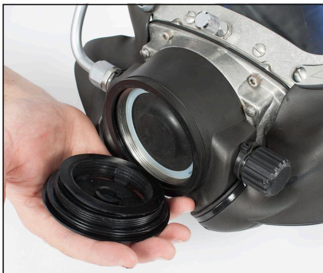
*Retire el anillo de sujeción y la cubierta del regulador.*
