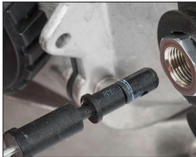
*Si instala un asiento nuevo en la válvula de entrada, debe dejar que el sellador de silicona se seque. Asegúrese de que la junta tórica esté instalada correctamente en el cuerpo de la válvula.*
