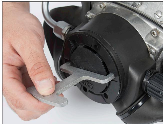
*Desenrosque el anillo de sujeción para empezar a desmontar la cubierta.*
