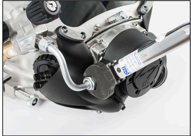
*Asegúrese de que la conexión entre el tubo curvado y el regulador quede firme.*
