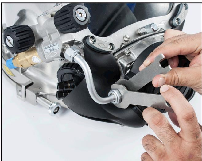
*El regulador se puede ajustar sin desmontar del casco.*
