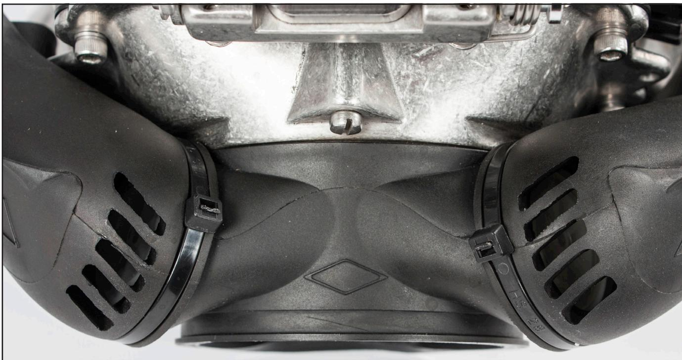
*Las bigoteras derecha e izquierda se deben alinear de modo que las líneas de moldeado en la parte inferior de las bigoteras queden alineadas con la línea de moldeado del cuerpo principal, y de que los cabezales de los precintos queden en la parte trasera del cuerpo. También puede hacer marcas en las bigoteras con un rotulador.*
