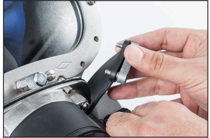
*Las bigoteras se sujetan al visor con dos tornillos de cada lado.*
