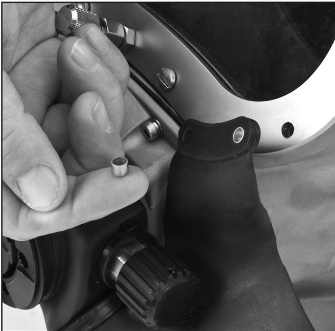
*Asegúrese de haber colocado los espaciadores de las bigoteras antes de ajustar los tornillos que sujetan las bigoteras.*
