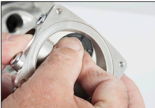
*Intente girar el asiento para ver si se instaló correctamente. No debería poder girarlo o debería resultar difícil hacerlo.*
