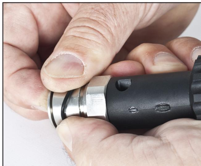
*Retire la junta tórica de la tuerca de presión de la perilla flexible. Puede usar una tarjeta de crédito, un mondadientes o cualquier dispositivo suave y limpio que no dañe la junta tórica ni la tuerca.*
