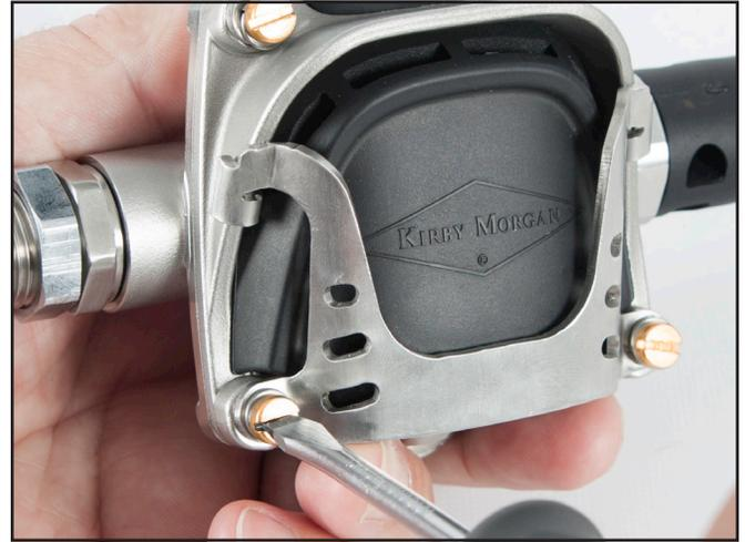
*Ajuste los tornillos de manera uniforme.*
