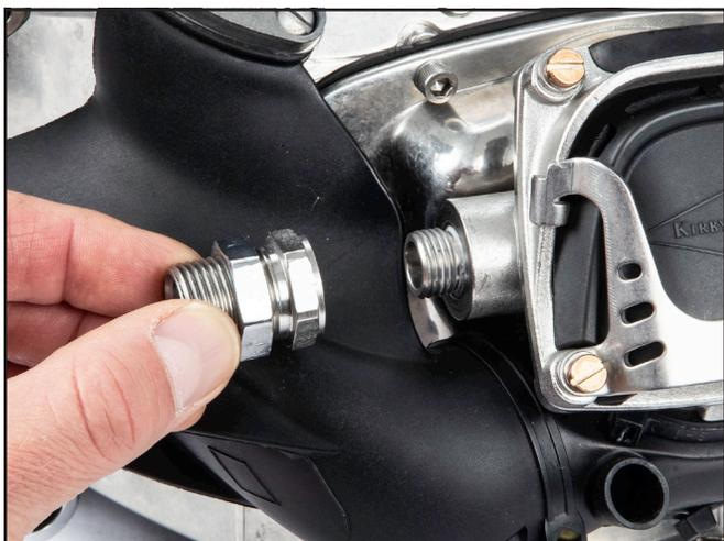
*Retire el adaptador del tubo curvado.*
