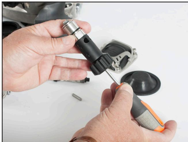
Para desmontar la perilla flexible debe retirar por completo la varilla de ajuste. **NO INTENTE SEPARAR LA PERILLA y LA TUERCA DE PRESIÓN sin RETIRAR PRIMERO LA VARILLA DE AJUSTE.**
