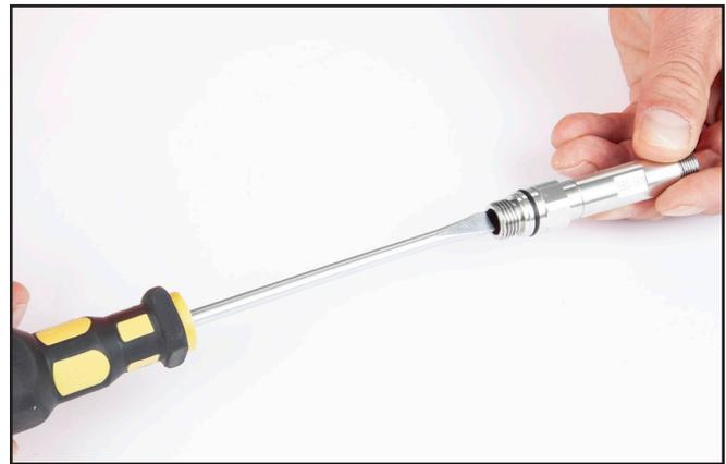
*Desatornille completamente la boquilla de ajuste del tubo principal.*
