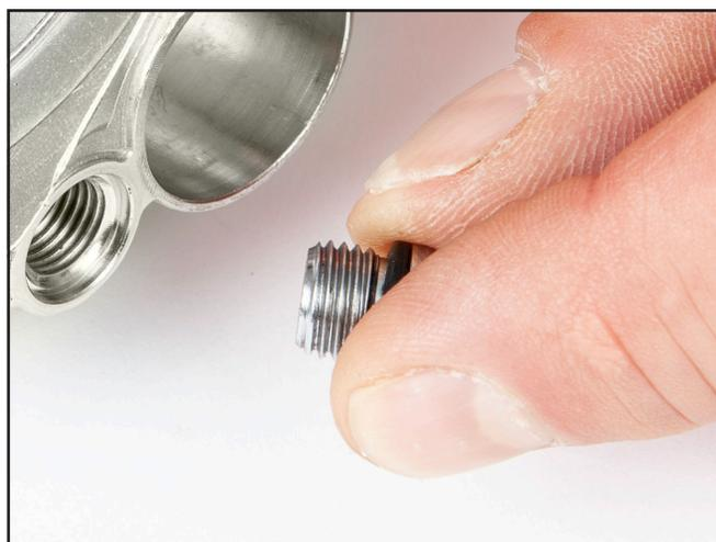
*Coloque una junta tórica en cada tapón roscado e instale los tapones en el cuerpo del regulador.*
