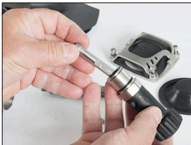
*Para separar la perilla flexible de la tuerca de presión debe retirar por completo la varilla de ajuste.*
