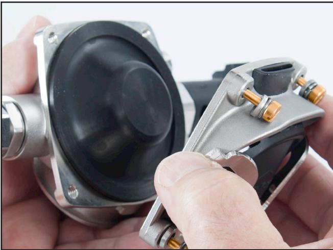
*Instale el conjunto del marco de retención de la cubierta del regulador en el cuerpo del regulador.*
