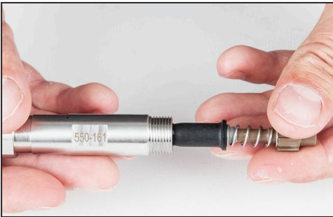
*Retire el conjunto del espaciador de compensación, el resorte y la válvula de entrada del tubo principal.*
