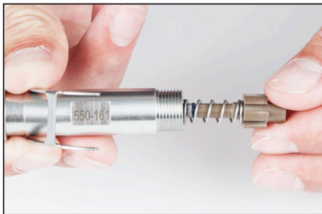
*Instale el resorte y el espaciador de compensación con las juntas tóricas en el tubo principal.*
