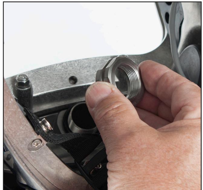
*Instale la tuerca de montaje del regulador. **TODAVÍA NO AJUSTE LA TUERCA.***
