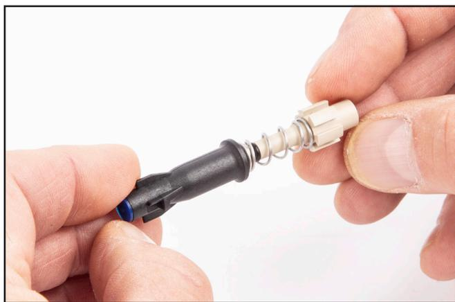
*Introduzca el espaciador de compensación con las dos juntas tóricas instaladas en el extremo abierto de la válvula de entrada y deténgase en la segunda junta tórica.*
