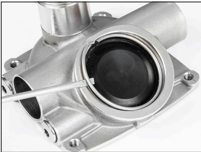
*Use un destornillador de cabeza plana pequeño para extraer el anillo de sujeción del asiento de la válvula de escape del cuerpo del regulador.*
