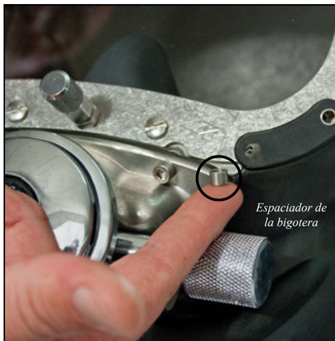
No pierda los espaciadores de las bigoterías.
