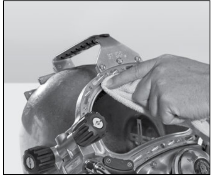
Antes de volver a colocar la junta tórica en el marco de retención del visor, limpie la ranura.
