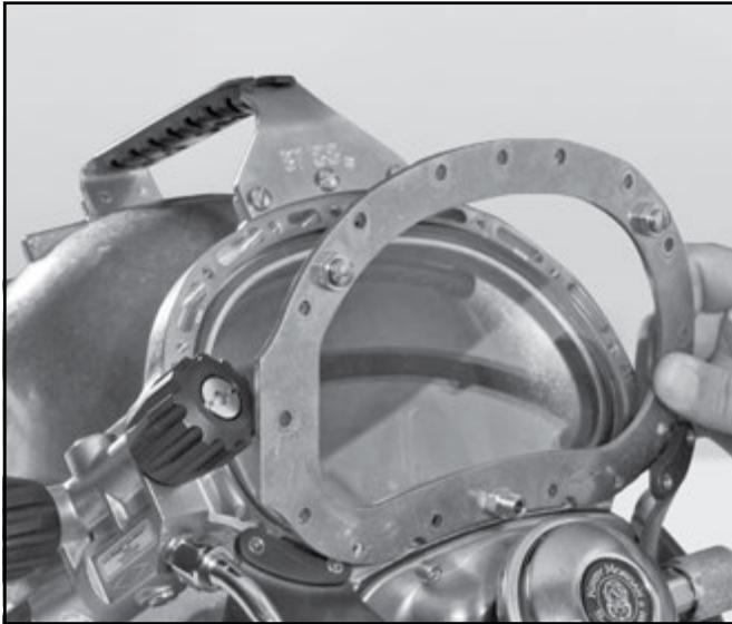
Retire el marco de retención del visor.
