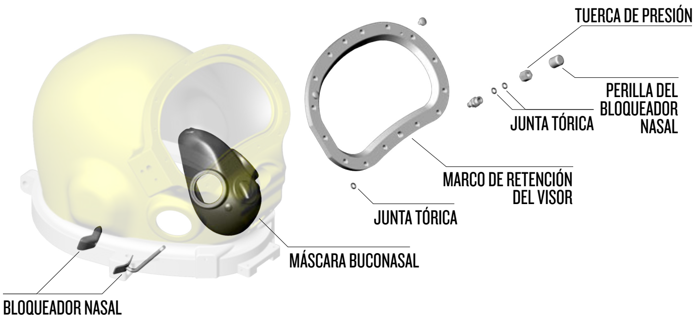
Vista despiezada del bloqueador nasal y sus componentes (igual que en las máscaras KMB-Band Mask).
