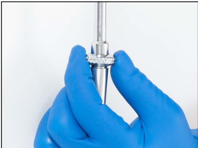
12) Quite la tuerca de seguridad con el destornillador de tuercas de 3/8" y coloque la arandela.
