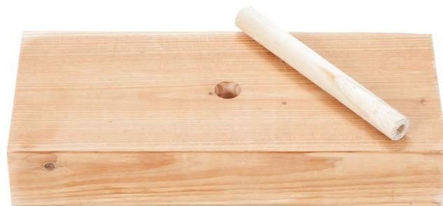
2) Perfore un agujero de 1/4" (6 mm) de diámetro y 1/4" (13 mm) de profundidad en un extremo de la clavija de madera. La clavija sirve para volver a asentar la junta tórica en la perilla del pasador. También puede insertarla en el bloque de madera y acoplar el pasador para llenar el cuerpo con aceite.
