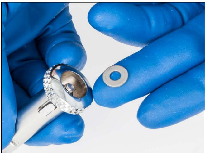
13) Vuelva a colocar la tuerca de seguridad en el extremo roscado del émbolo y ajústela con el destornillador de tuercas de 3/8" hasta que llegue hasta el fondo.
