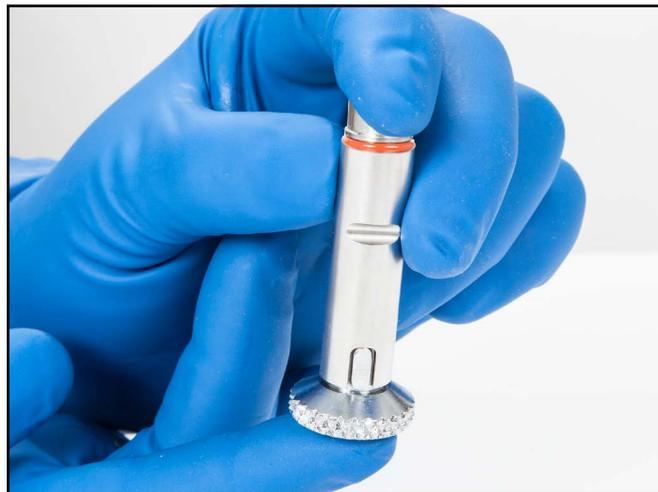
10) Con el destornillador de tuercas de 3/8", ajuste lentamente la tuerca y baje el extremo biselado de manera que la parte donde está la junta tórica se introduzca en el cuerpo. La junta tórica roja quedará oculta.
