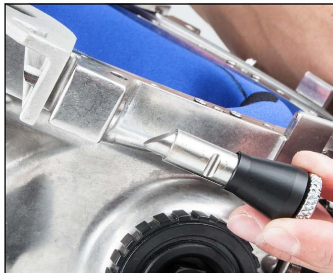
5) Si está reutilizando los tornillos originales, verifique que las roscas estén limpias y aplique una pequeña cantidad de fijador de roscas Loctite® 248 a los extremos de los tornillos. Si va a utilizar tornillos nuevos, no es necesario aplicar Loctite® (ni ningún otro producto), porque ya vienen con el fijador de roscas aplicado.
