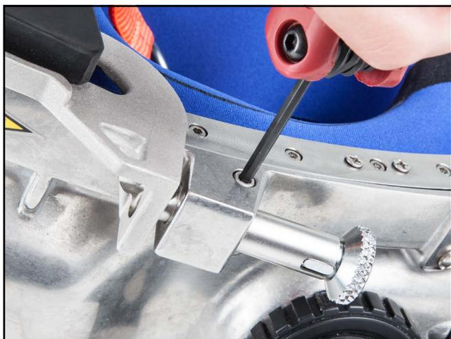
2) Sujete el extremo de la perilla del pasador fiador y, con el destornillador de tuercas de 3/8", afloje y quite la tuerca de seguridad.
