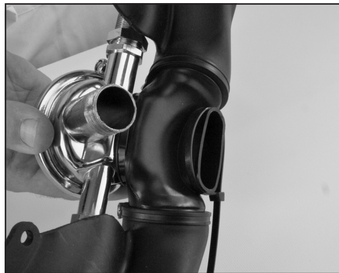
Coloque un precinto, pero no lo ajuste.
