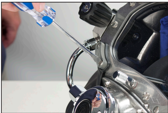
Retire los tornillos que sujetan los ánodos de zinc, los espaciadores de las bigoterías y las bigoterías.
