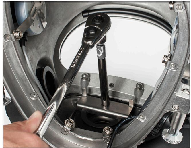
*Afloje la tuerca de montaje del regulador para que sea más fácil desmontar la carcasa.*
