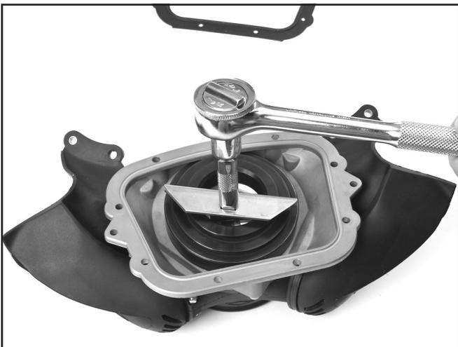
*Extracción de la tuerca de montaje del regulador.*
