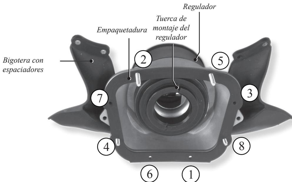
En esta foto se muestra la carcasa con el regulador acoplado, como se ve desde el interior del casco. Los números indican el orden en el que se deben aflojar los tornillos y las tuercas que sujetan la carcasa para desmontarla del casco. Afloje los tornillos gradualmente, de a uno.
