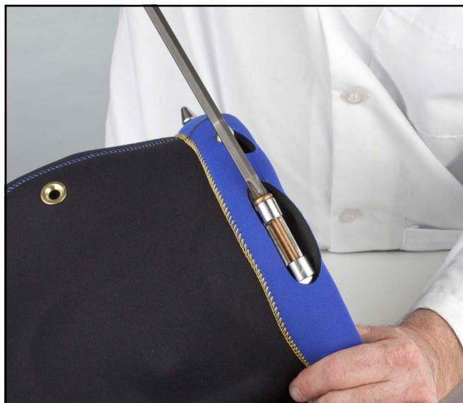
3) Instale el espaciador del sello facial (n.º de pieza 520-153) en el sello facial moldeado (este espaciador solo es necesario en las máscaras BandMask KMB 28. El modelo KMB 18 no lo necesita).
