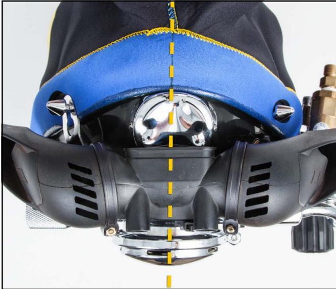
6) Usando un destornillador dinámico con punta Phillips grande, ajuste los tornillos de las bandas. **CONSULTE SIEMPRE** el módulo “Apéndice”, página APNDX-19, sección “Pares de apriete” para confirmar el par de apriete correcto.
