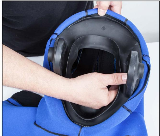
**NOTA:** cuando las capas de nailon o neopreno se desprenden una de otra, se produce delaminación. Realice el paso 8) de forma lenta y continua, para no delaminar ni romper el nailon al separarlo del neopreno, en especial cerca de las costuras de la capucha. Avance por el contorno de la capucha; desprenda las superficies con un movimiento descendente hacia el borde delantero del sello facial.
