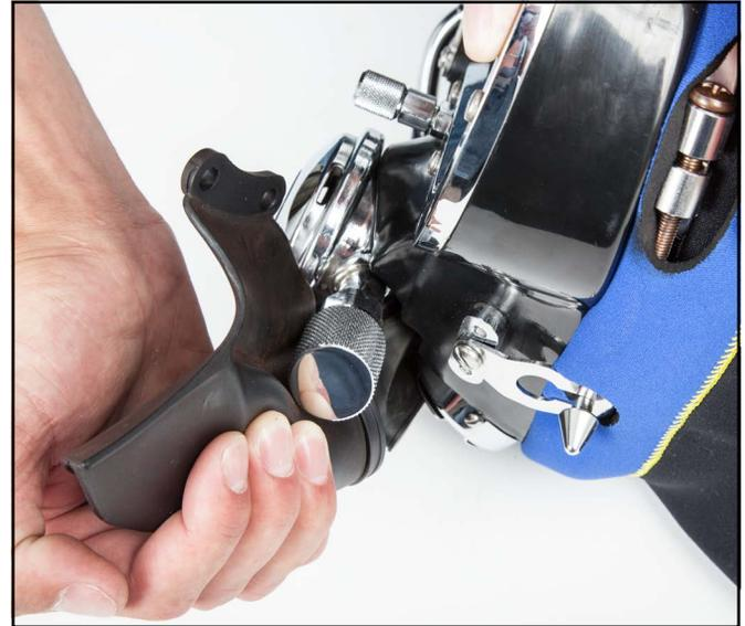
Si realizó el paso opcional de mover la bigotera izquierda, regrésela a su posición original. Coloque los tornillos, los espaciadores y el ánodo de zinc o la placa reniforme y ajuste los tornillos a 12 lbf in (1,3 N·m).
