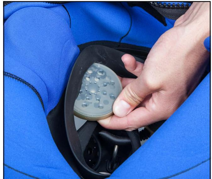
**NOTA:** puede instalar los auriculares más fácilmente aplicando una pequeña cantidad de detergente o de lubricante de silicona para bombas en el exterior de los conjuntos de los auriculares.
