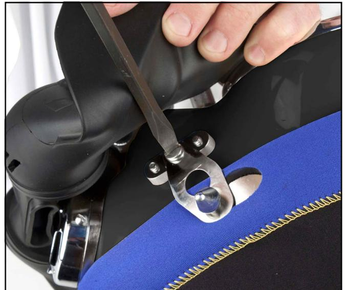
2) Retire los tornillos de ajuste de las bandas. Si instalará un nuevo sello facial moldeado, deséchelos y use los tornillos del kit.
