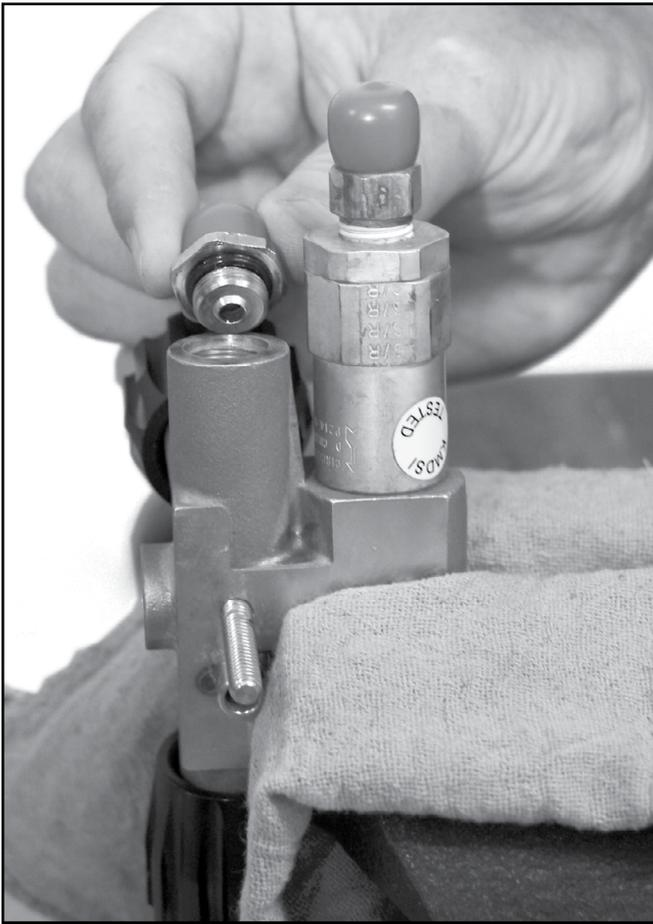
*El adaptador o boquilla de entrada de la válvula de EGS debe desmontarse de forma periódica para revisar la junta tórica y para facilitar la limpieza del interior del bloque lateral. Recuerde que el perno que se usa para sujetar el bloque lateral se fija con Loctite® 222. El mantenimiento de este elemento solo puede estar a cargo del distribuidor.*
