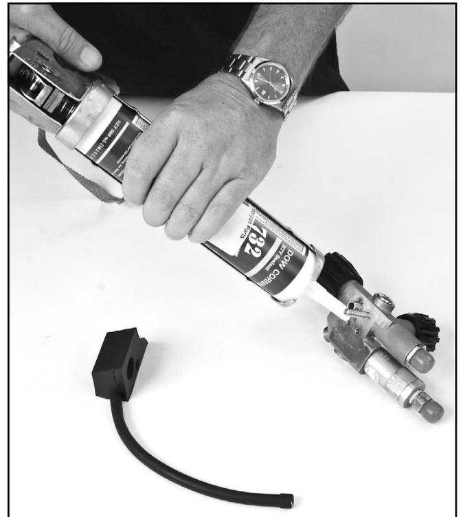
*Aplique de manera uniforme una pequeña cantidad de sellador de silicona al bloque lateral antes de instalarlo en el armazón del casco. Use únicamente sellador multiuso de silicona RTV Dow Corning® 732 o similar.*
