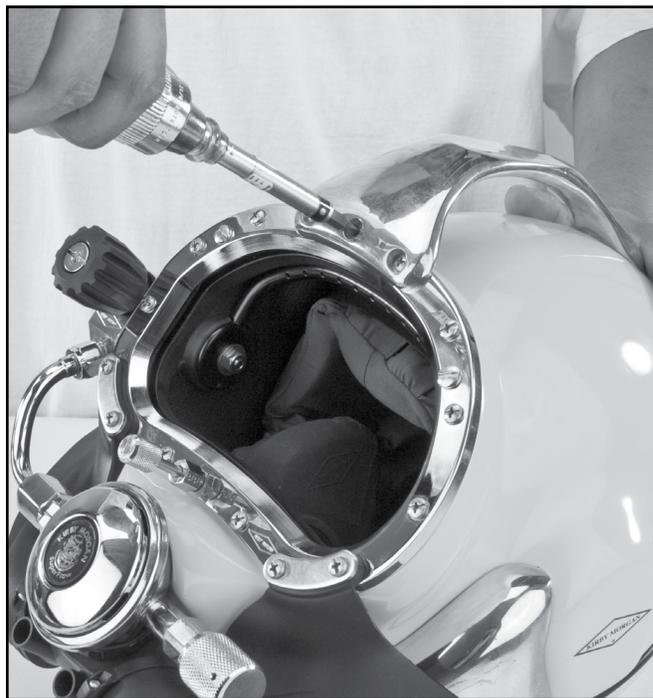
Use un destornillador dinamométrico para ajustar la parte delantera de la agarradera. Consulte el módulo "Apéndice", página APNDX-19, sección "Pares de apriete".
