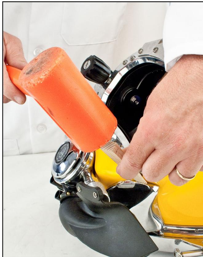
Use una cuña de madera y un mazo para romper el sello entre el contrapeso y el armazón del casco. **NO USE UN DESTORNILLADOR NI UN CINCEL O FORMÓN PARA SEPARAR EL CONTRAPESO.** Podría dañar el armazón del casco, y la reparación es costosa.
