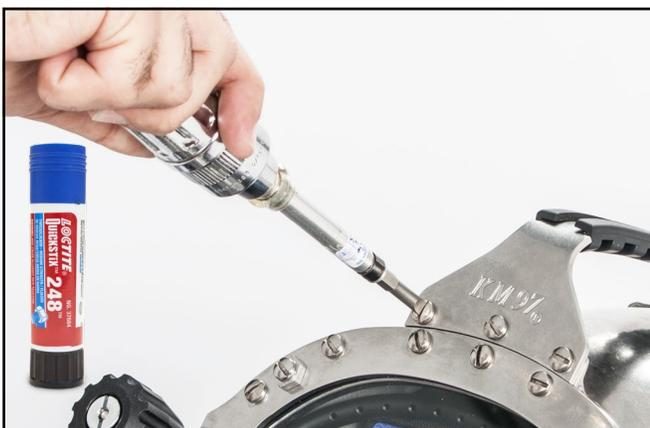
*Ajuste los tornillos de la parte delantera de la agarradera según las especificaciones del módulo “Apéndice”, página APNDX-19, sección “Pares de apriete”.*
