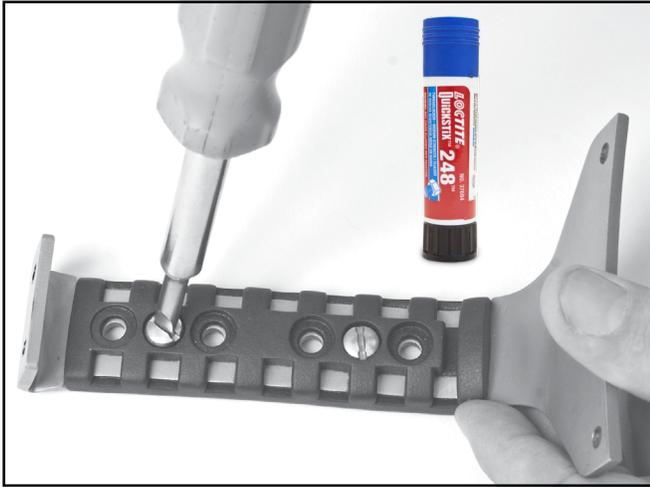
*Ajuste los tornillos hasta que queden apenas hundidos en el caucho. Las puntas sobresaldrán levemente por el otro lado de la agarradera.*
