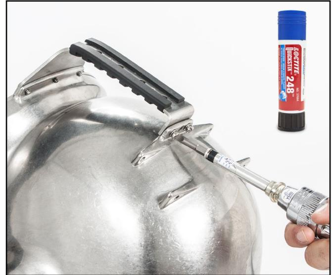
*Ajuste los tornillos de la parte trasera de la agarradera según las especificaciones del módulo “Apéndice”, página APNDX-19, sección “Pares de apriete”.*
