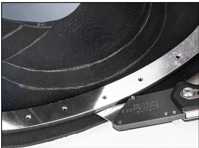
Recorte el sobrante de neopreno con una cuchilla de afeitar.
