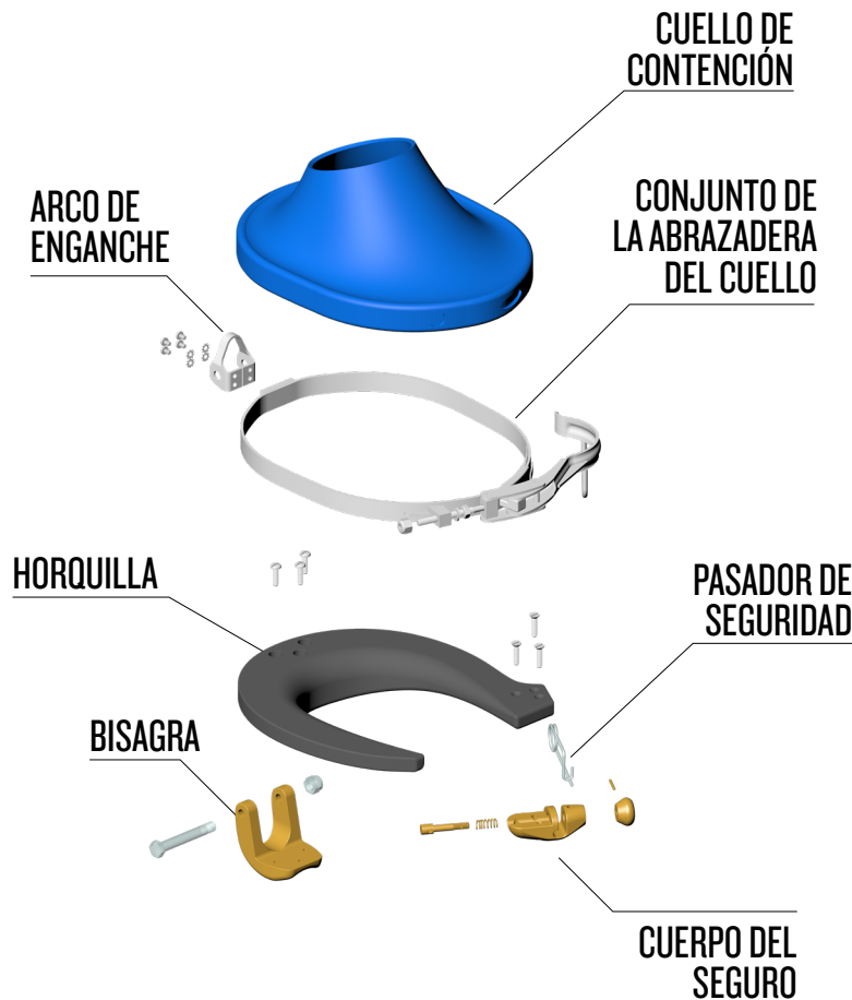
Componentes del conjunto de la abrazadera del cuello y la horquilla
