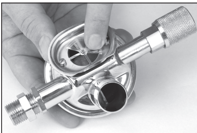
La válvula de escape debe estar en buenas condiciones.
