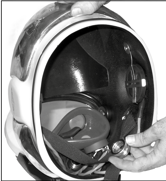
Retire la tuerca de montaje del regulador.
