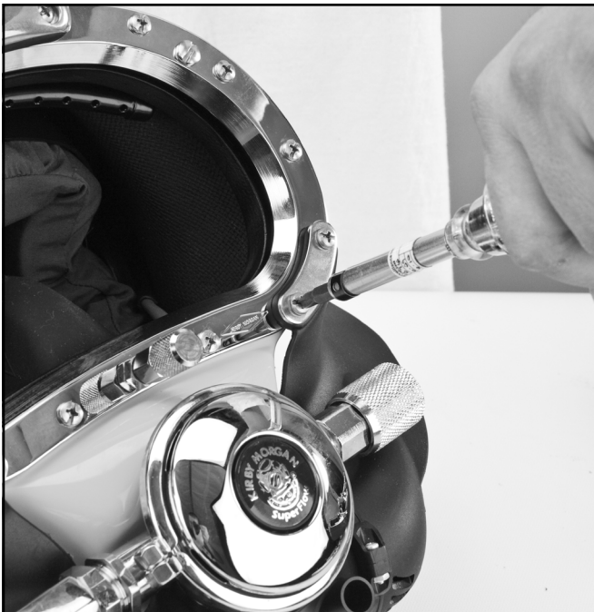
Retire las bigoterías del casco.
