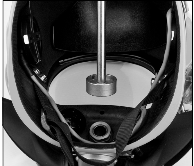
La tuerca de montaje del regulador se debe aflojar con una llave.
