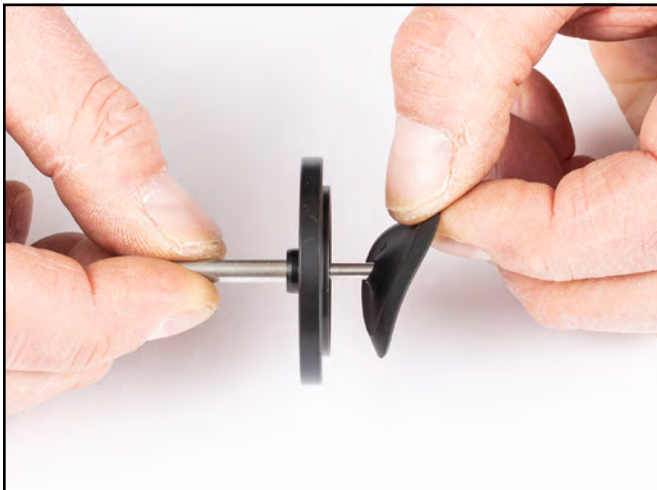
7) Retire la válvula del conjunto del disco.
