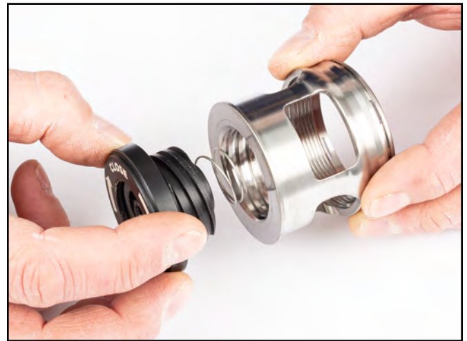
9) Gire el resorte en sentido horario y tire de él un poco hacia afuera para separarlo del cuerpo.
