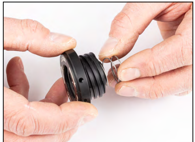
9) Gire el resorte en sentido horario y tire de él un poco hacia afuera para separarlo del cuerpo.
