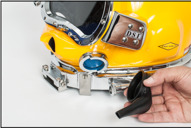
El deflector de purga de agua se desmonta cortando el precinto que lo sujeta.
