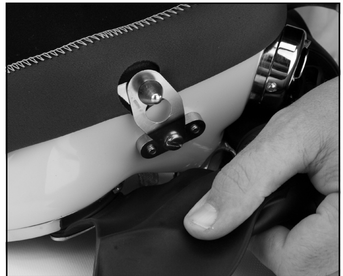
Para acceder a la guarda de la banda inferior para ajustarla, debe desplazar la bigotería.
