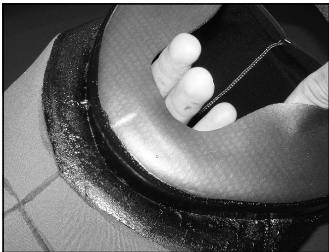
Comience a unir el sello facial a la capucha por la zona central inferior de ambas piezas.
