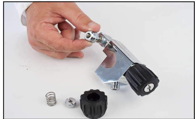
Instalación del vástago de la válvula en la válvula de emergencia.
