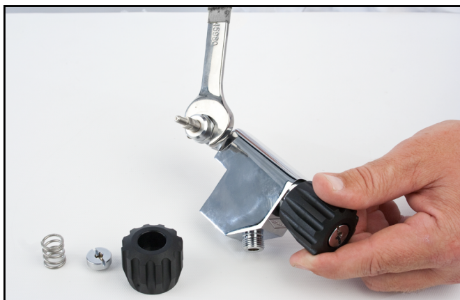
Desenrosque la tuerca de presión.
