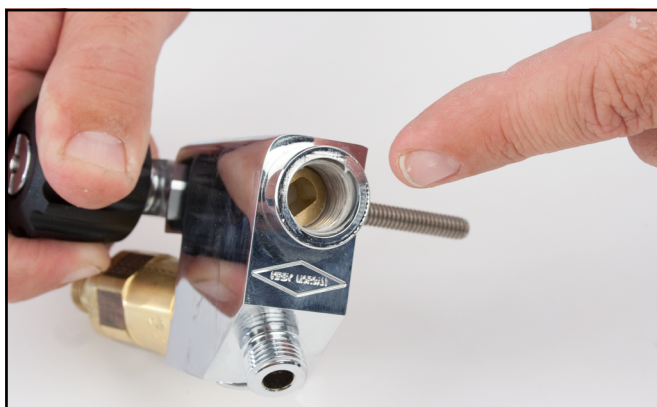
Debe desmontar el asiento para revisarlo.
