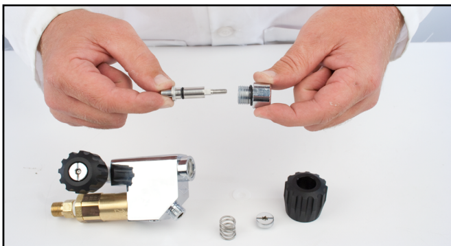
El vástago de la válvula suele salir con el casquete.
