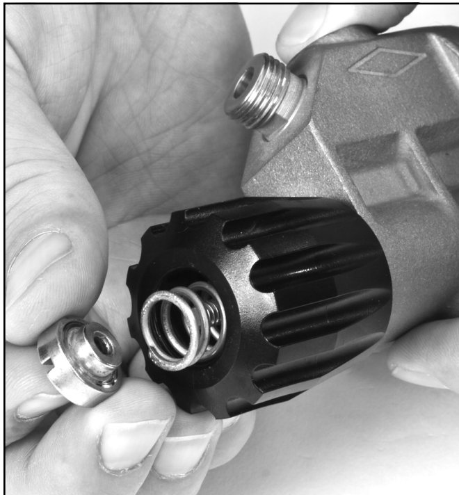
Quite la tuerca de la perilla de la válvula de flujo constante.
