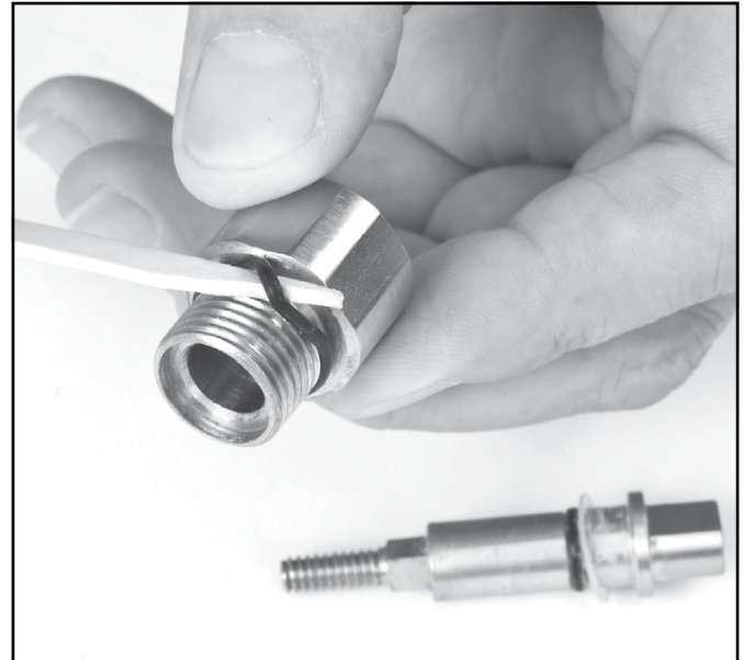
Use un mondadientes, una tarjeta de crédito o algún otro objeto no metálico para quitar las juntas tóricas y limpiarlas o cambiarlas. Tenga en cuenta que el casquete de la válvula de EGS es más corto que el de la válvula de flujo constante.
