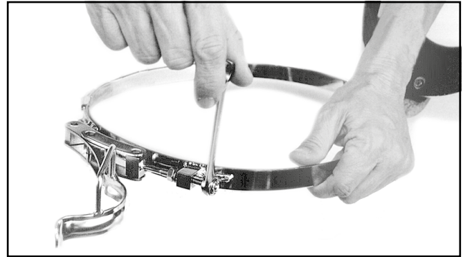
La abrazadera del cuello y el seguro deben funcionar correctamente. Revíselas y realice el mantenimiento necesario con regularidad.
