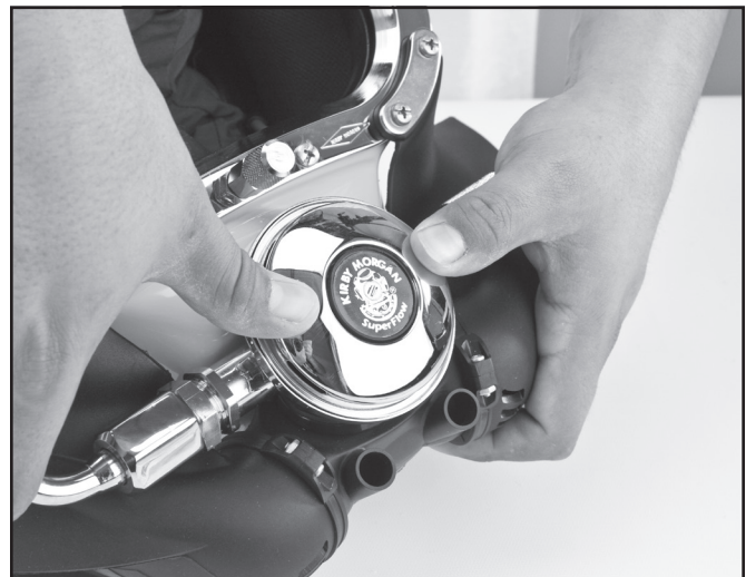
Empuje hacia abajo la cubierta del regulador para simular una abrazadera ajustada.
