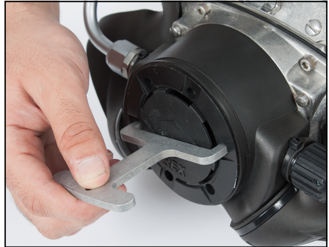
Desenrosque el anillo de sujeción para empezar a desmontar la cubierta.
