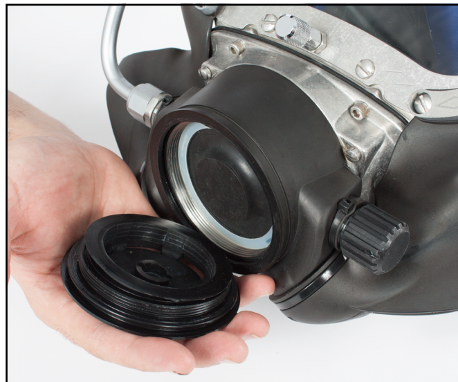
Retire la cubierta del regulador para revisar el diafragma.
