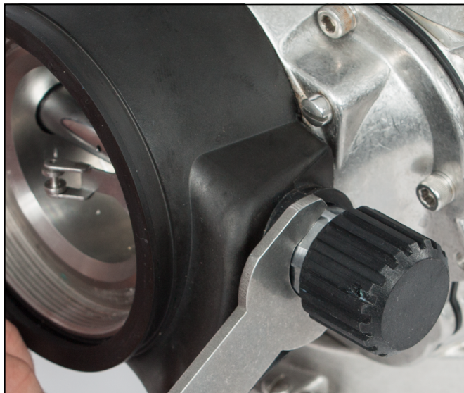
Ajuste la tuerca de presión en la perilla de ajuste.
