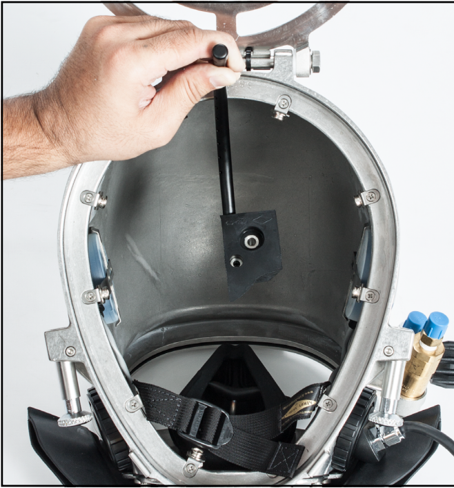
Instale el conducto de aire y el cuerpo del conducto de aire dentro del casco.
