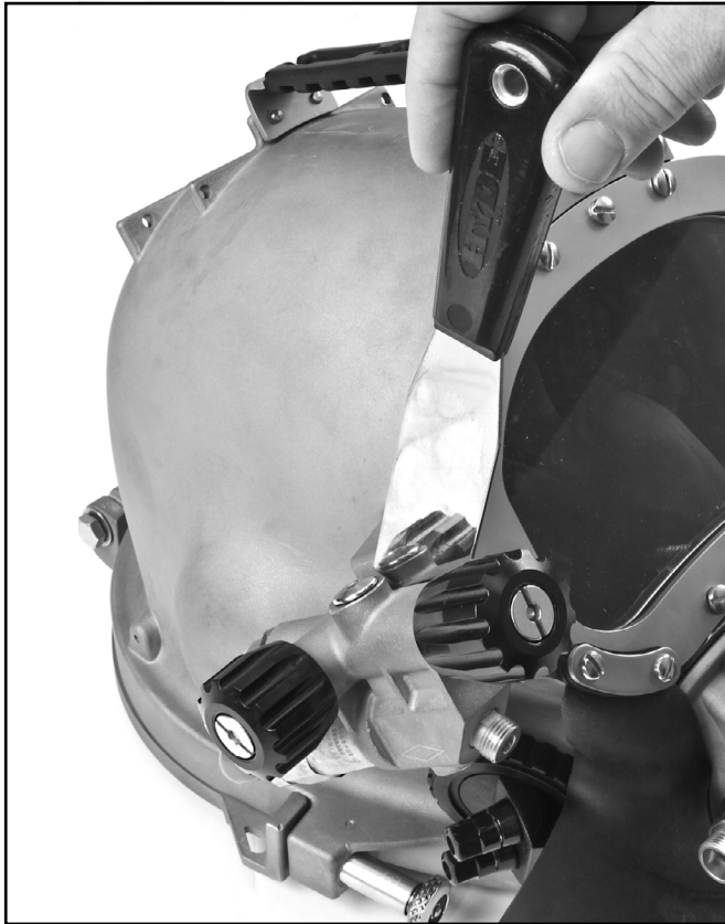
Puede introducir una espátula delgada entre el bloque lateral y el armazón del casco para ayudar a desmontar el bloque lateral.
