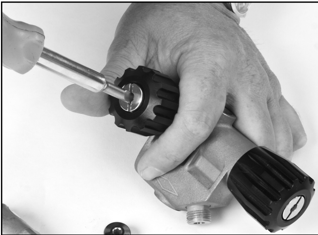
Ajuste la tuerca que sujeta la perilla.
