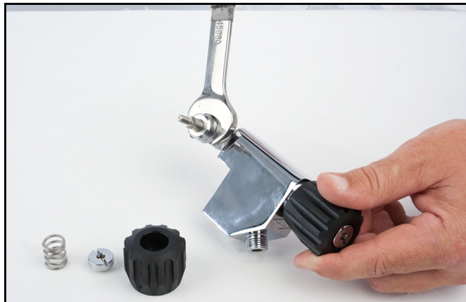
Desenrosque la tuerca de presión.
