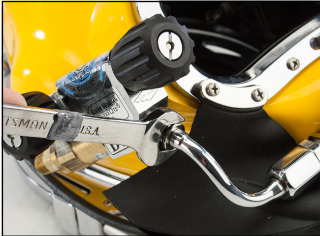
En esta imagen se muestra cómo aflojar el tubo curvado desde el extremo del bloque lateral.
