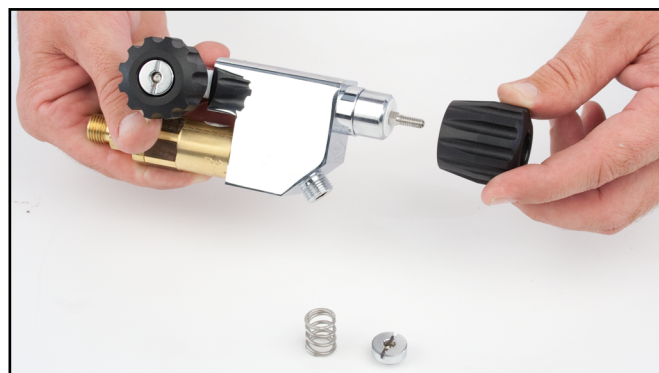
Retire la perilla de control del flujo constante.
