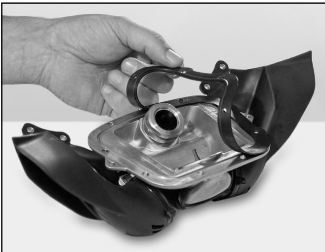
Retire la empaquetadura para su limpieza o reemplazo. Observe el reborde de la empaquetadura. Este reborde está diseñado para ayudar a mantener la posición correcta de la empaquetadura en la ranura de la carcasa.
