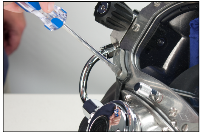
Retire los tornillos que sujetan los ánodos de zinc, los espaciadores de las bigoteras y las bigoteras.
