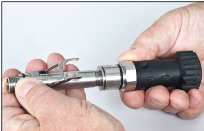
Desenrosque el conjunto de la perilla flexible del tubo principal.
