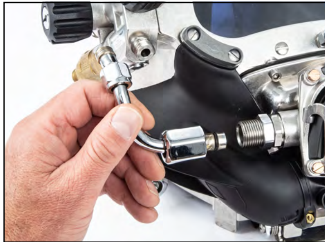
Retire el conjunto del tubo curvado.
