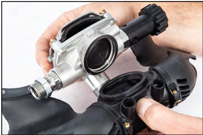
Separe el regulador del sistema de escape Quad-Valve™.
