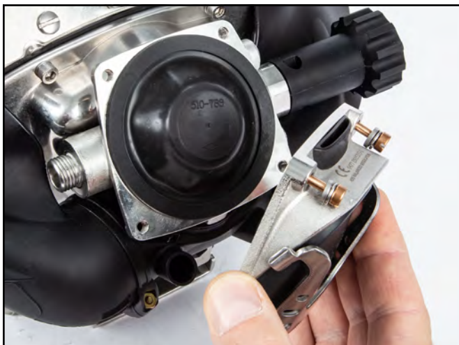
Afloje los tornillos y las arandelas de ambos lados de la cubierta.
