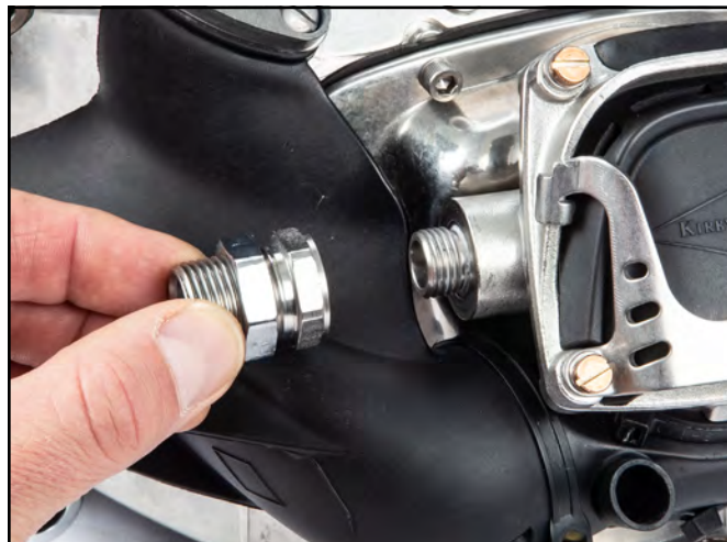
Retire el adaptador del tubo curvado.
