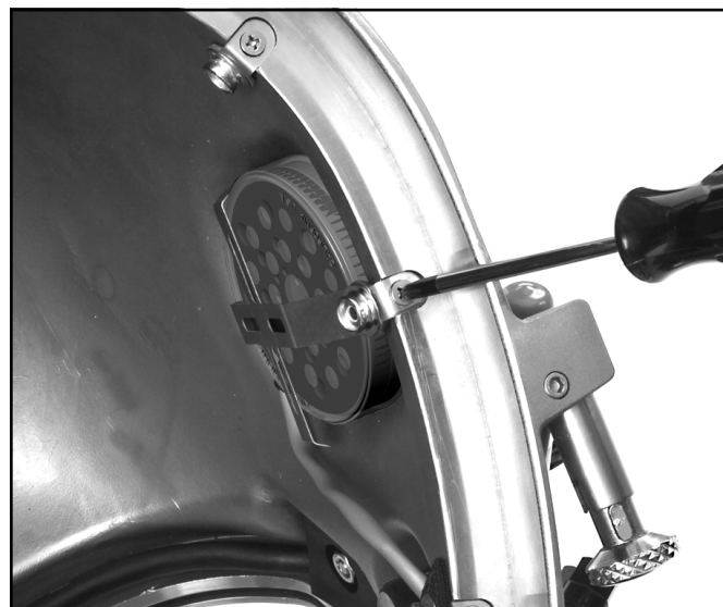
Desmontaje de la lengüeta con broche de presión que sujeta también la abrazadera en cruz de uno de los auriculares.
