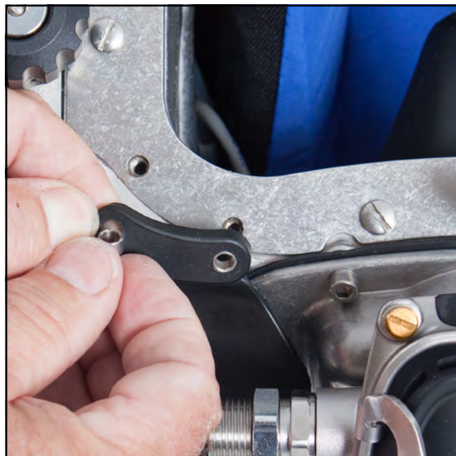
Sujete las bigoterías a cada lado del marco de retención del visor con los tornillos, los ánodos de zinc o las placas reniformes y los espaciadores.
