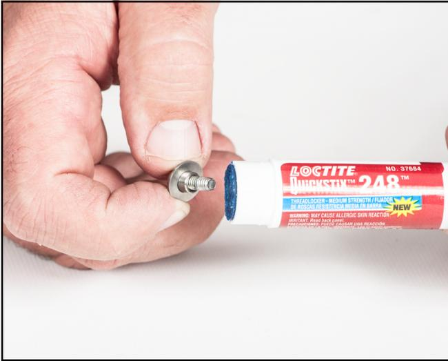
*Antes del montaje, aplique un poco de fijador de roscas Loctite® 248 a todos los tornillos del conjunto de la traba.*
