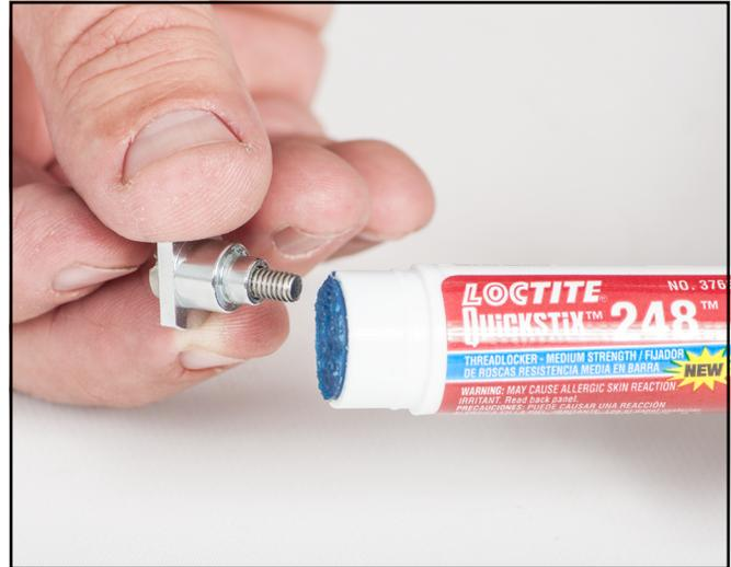
*Antes del montaje, aplique un poco de fijador de roscas Loctite® 248 a las roscas del espaciador del resorte.*
