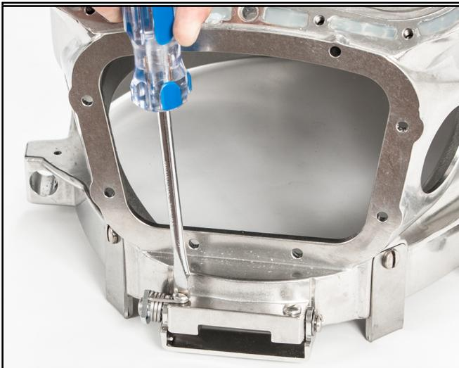
Para reemplazar el resorte, también debe retirar el tornillo de la parte superior derecha de la parte fija de la traba. Para tener acceso a este tornillo, debe desmontar el conjunto del regulador y la carcasa o usar un destornillador de 90 grados.
