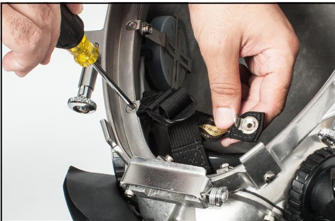
*La correa para el mentón debe instalarse de forma tal que, con el casco colocado en la cabeza, se ajuste tirando hacia la derecha.*
