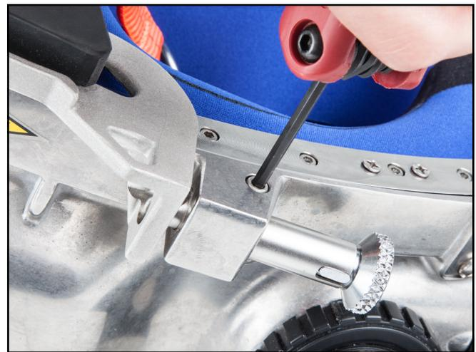
2) En los cascos de acero inoxidable, los casquillos se deben recortar por la línea de corte. Este recorte no es necesario cuando los casquillos se usan en cascos de fibra de vidrio.
