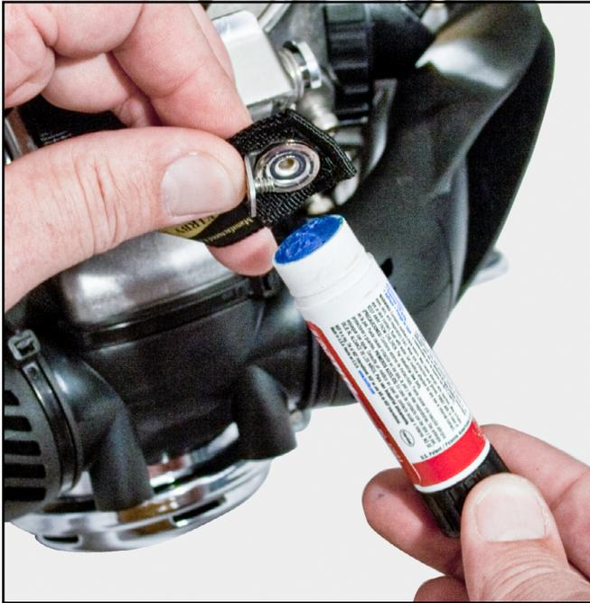
*Aplique fijador de roscas Loctite® a los tornillos que sujetan la correa para el mentón.*
