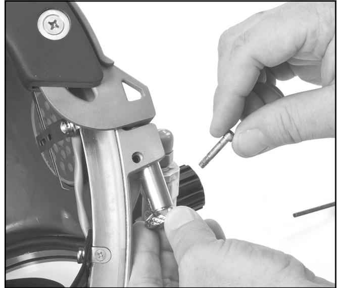
*Los tornillos que sujetan los pasadores fiadores sellados se deben instalar y ajustar correctamente.*
