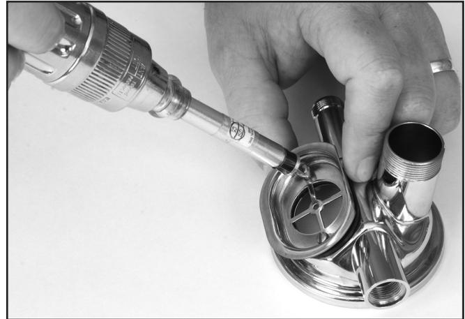
Los tornillos que sujetan la brida al cuerpo del regulador deben ajustarse al par de apriete correcto, que se especifica en el módulo "Pares de apriete".
