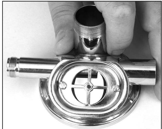
Si la brida está demasiado ajustada, la junta sobresaldrá en la abertura de la válvula de escape y hará que el rendimiento del regulador no sea óptimo.
