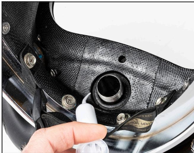
25. Coloque la junta tórica de sellado y ajuste manualmente la tuerca de montaje del regulador.
