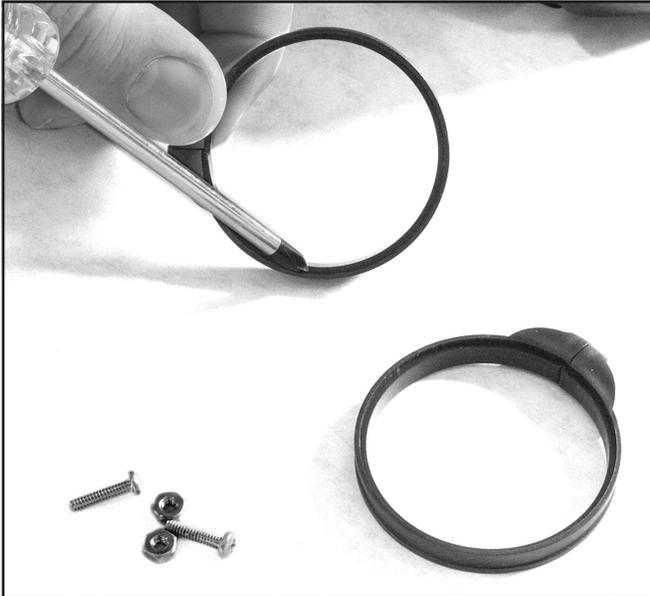
*Note que el interior de las abrazaderas de bigotera tiene una superficie escalonada. Las abrazaderas deben estar orientadas en la posición correcta para retener la bigotera de manera adecuada: el escalón inferior debe apuntar al regulador.*
