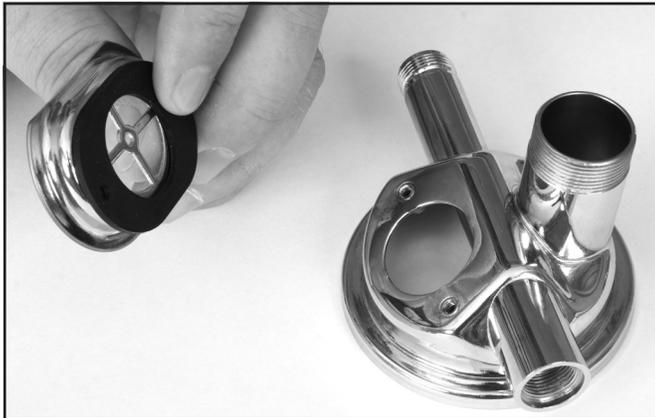
La empaquetadura debe instalarse entre la brida y el cuerpo del regulador.
