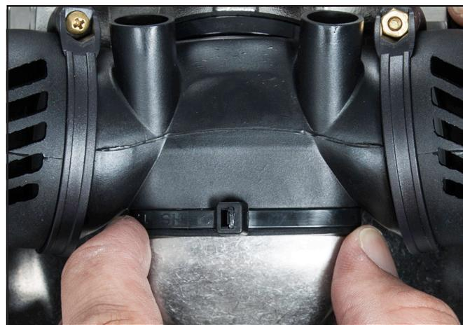
*El sistema de escape Quad-Valve se debe conectar correctamente al regulador y al acople del sistema de escape Quad-Valve de la carcasa.*
