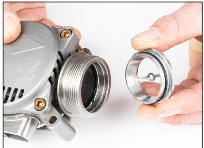
8) Encaje el anillo de sujeción de la carcasa por encima del cuerpo de la válvula de sobrepresión, de manera que quede apoyado en el conjunto pero lejos de las roscas de la válvula de sobrepresión.
