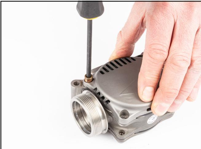
17) Retire los bloques de montaje. Preste atención a la dirección de la flecha para cuando vuelva a instalarlos.
