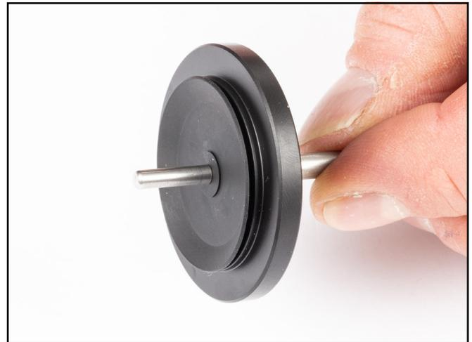
6) Introduzca el disco con pasador y la válvula en el apoyo del disco.
