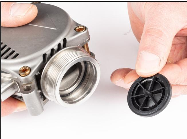
5) Introduzca el anillo de sujeción en el cuerpo de la válvula de sobrepresión.
