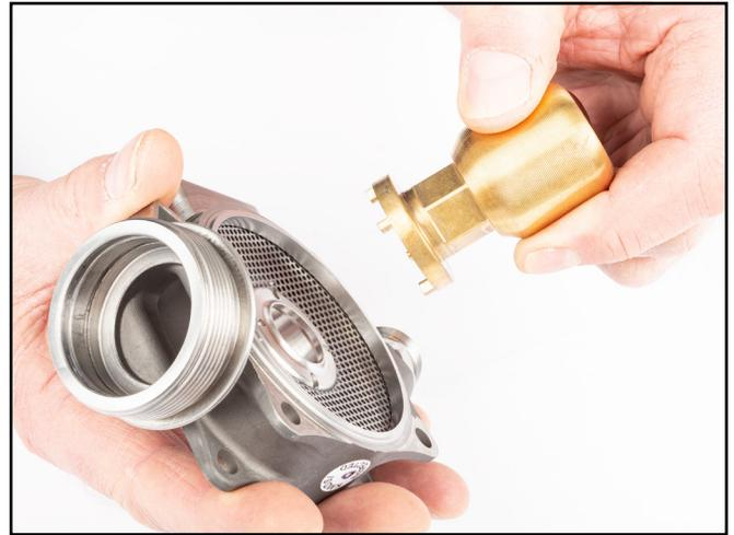
2) Coloque el conjunto de manera tal que la herramienta grande de latón quede debajo y el asiento de la válvula con las ranuras quede hacia arriba.
