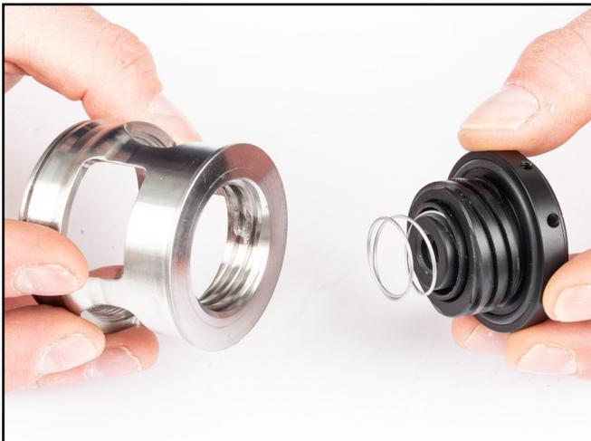
5) Haga pasar el agujero de la válvula por el vástago. La parte cóncava debe apuntar hacia arriba y debe bajar la válvula hasta que quede sujeta en la acanaladura del vástago.
