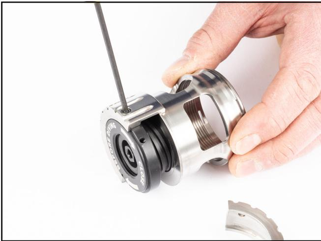
7) Retire la válvula del conjunto del disco.
