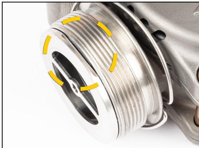
11) Use un destornillador de cabeza plana grande para **extraer el apoyo haciendo palanca hacia afuera de manera uniforme, alternando entre los lados para aflojarlo parejamente.**
