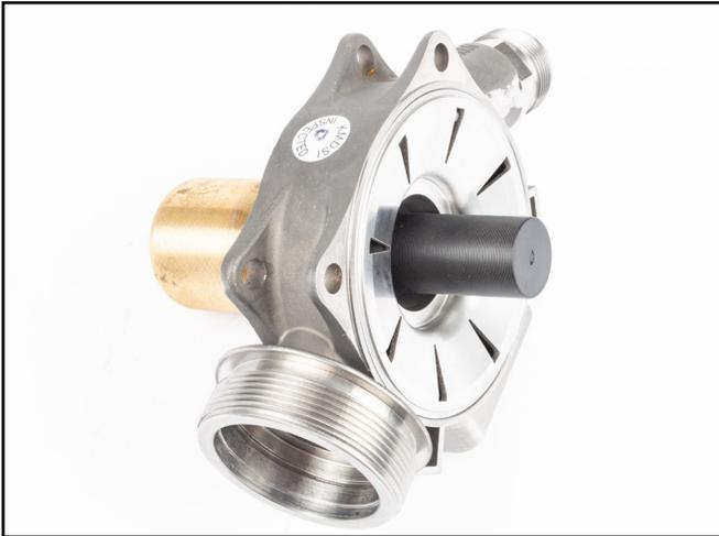
4) Cuando ambas partes de la herramienta estén sujetas, use la llave de 3/4" para girar la parte de latón en sentido horario; de esta manera, aflojará el asiento.
