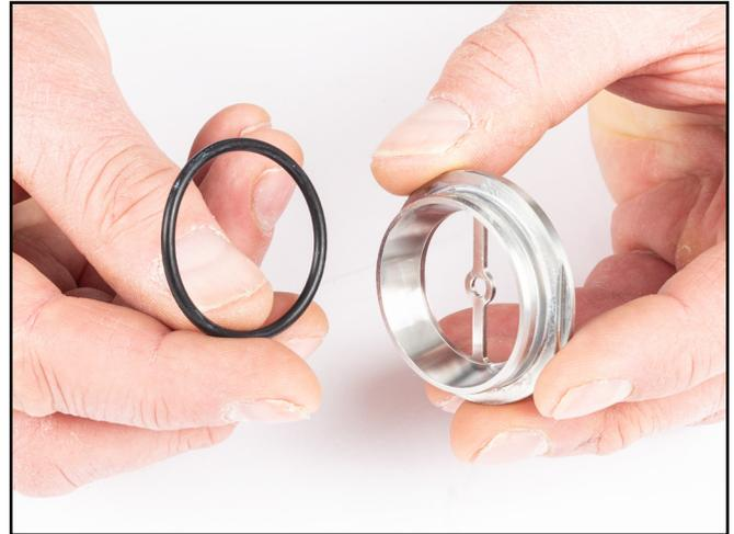
7) Introduzca el apoyo del disco con la junta tórica de manera alineada en el cuerpo de la válvula de escape, y presione **UNIFORMEMENTE** hasta que quede completamente apoyado.
