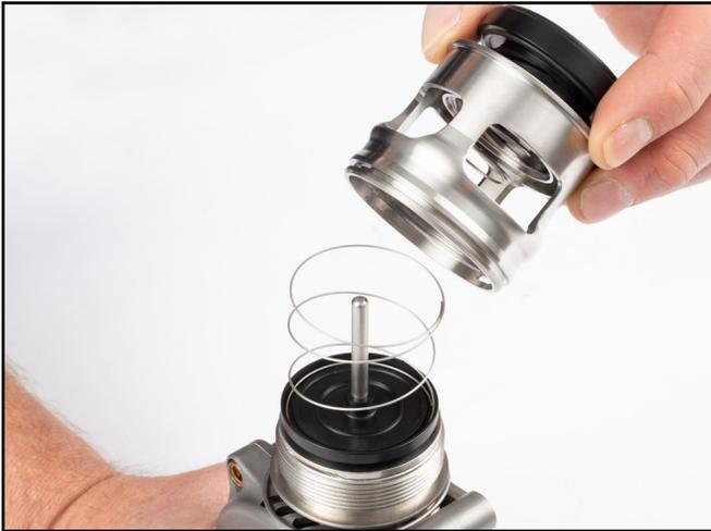
11) Instale el anillo de sujeción en la carcasa engancho un extremo a la vez. Use los dedos para ir encajando el anillo alrededor de la carcasa hasta que el segundo extremo quede sujeto.
