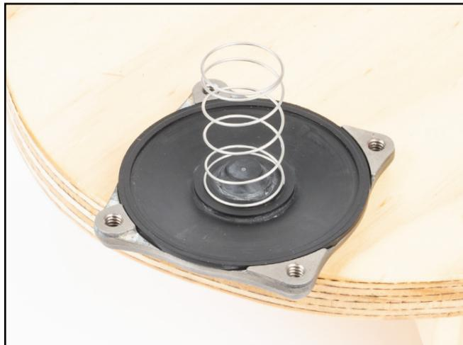
8) Apoye el cuerpo del regulador sobre la cubierta inferior del diafragma, con el diafragma y el resorte colocados.
