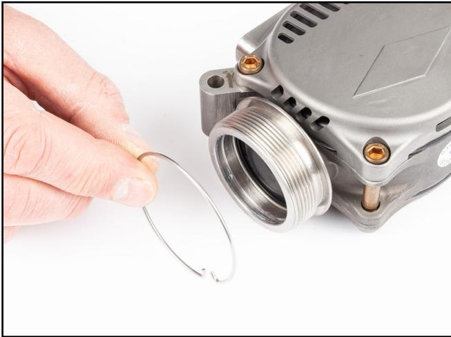
14) Extraiga los componentes de la válvula de sobrepresión del cuerpo del escape del Diamond. Primero, use un destornillador pequeño para extraer el anillo de sujeción.
