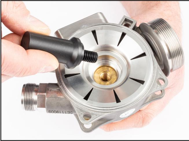
El extremo roscado de la herramienta debe atravesar el agujero y acoplarse con la parte de latón, que está sujeta del lado de la rejilla (segunda etapa) del regulador de escape.
