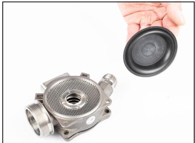
19) Para finalizar el desmontaje del regulador de escape, retire la cubierta inferior, el diafragma de la segunda etapa y el resorte.
