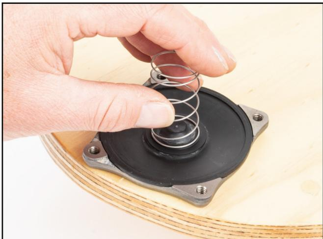
7) Coloque el diafragma en el centro con el resorte apoyado en la cubierta inferior (rejilla), de manera que coincidan los espacios en todo el borde superior.
