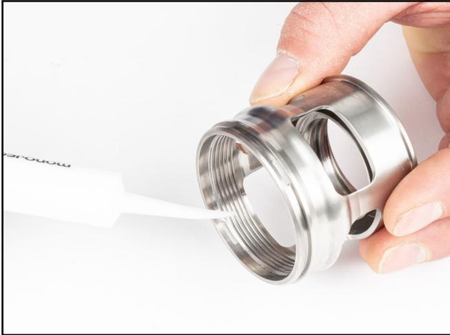
4) Enrosque el cuerpo de la perilla de control del escape con el resorte en la carcasa.
