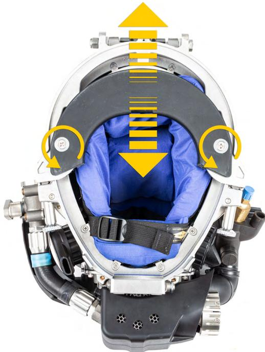
El componente principal que sujeta la cabeza al casco es el respaldo para el cuello en el collar de sujeción. El collar de sujeción se debe adaptar a cada buzo. El respaldo para el cuello se sujeta al collar de sujeción mediante dos tornillos de ajuste. Use estos tornillos para posicionar el respaldo para el cuello.
