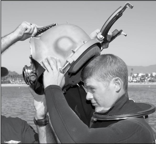
*Abra completamente el conjunto del collar de sujeción y el respaldo para el cuello.*
