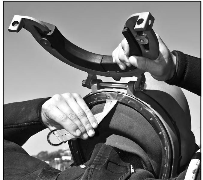
*Después de abrir el collar de sujeción, tendrá que tomar la correa y tirar hacia abajo para romper el sello; así podrá separar el conjunto de anillos del cuello del casco.*
