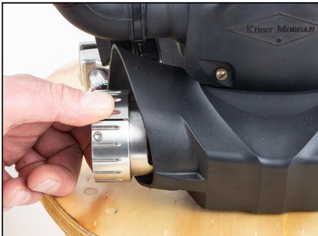
2) Primero, si había colocado un tapón en el tubo de recolección del conjunto de purga de agua, retírelo. Coloque un vaso pequeño debajo del puerto de salida del conjunto de purga de agua.
