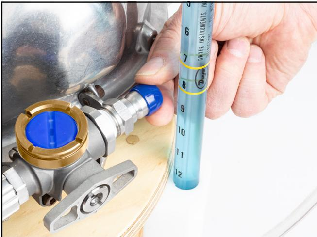
9) Verifique que la válvula de desvío de superficie esté en posición abierta (en paralelo).
