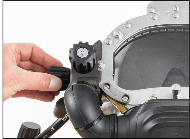
16) Abra lentamente la válvula de flujo constante hasta que la burbuja indicadora en la escala del manómetro esté por debajo del 0, pero no más abajo que la marca del 1. Debería escuchar un leve siseo de aire.
