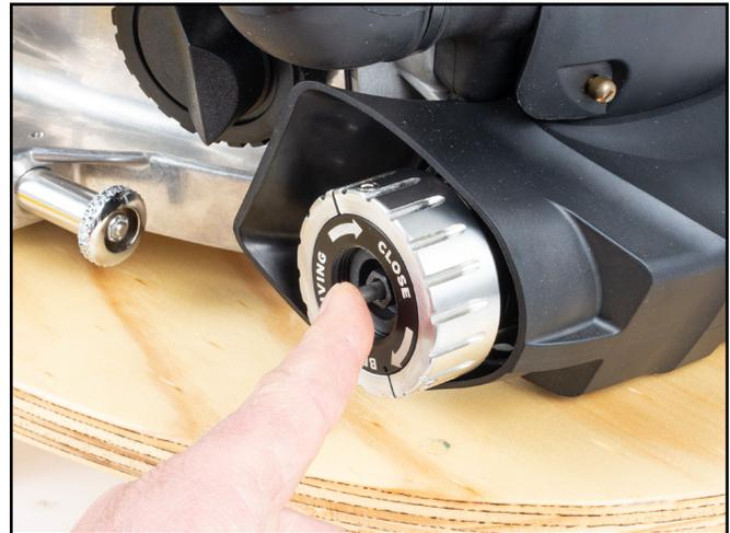
La aparición de burbujas indica que se abrió la válvula de vaciado de agua.
