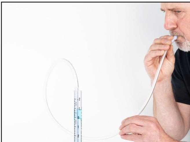
3) Desconecte el tubo del manómetro una vez que el medidor esté en 0 y no haya burbujas en el sistema.
