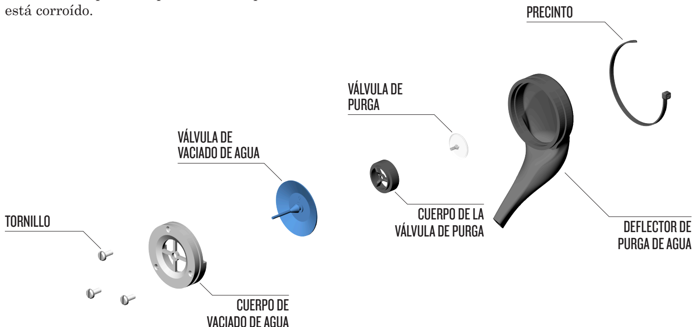
Componentes del conjunto de vaciado de agua del casco SuperLite® 27®
