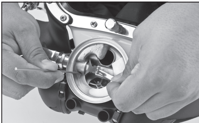
Inserte el sujetador de la válvula de entrada en el orificio de compensación del tubo de entrada.
