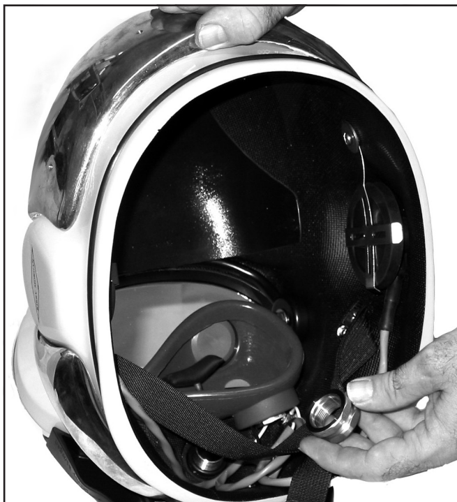
Retire la tuerca de montaje del regulador.
