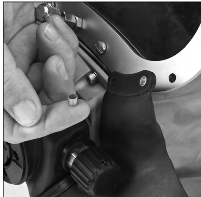
Asegúrese de haber colocado los espaciadores de las bigoterías antes de ajustar los tornillos que sujetan las bigoterías.
