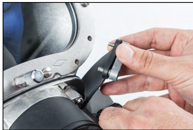
Las bigoterías se sujetan al visor con dos tornillos de cada lado.
