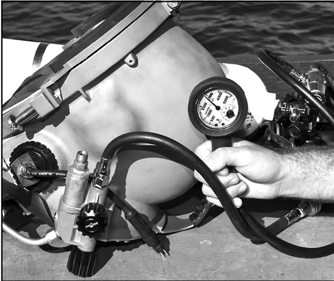
*Verificación de la válvula antirretorno. Si conecta la botella auxiliar a la válvula de emergencia, no debería salir gas por la válvula antirretorno cuando se abren la válvula de suministro de gas de emergencia y la válvula de la botella.*
