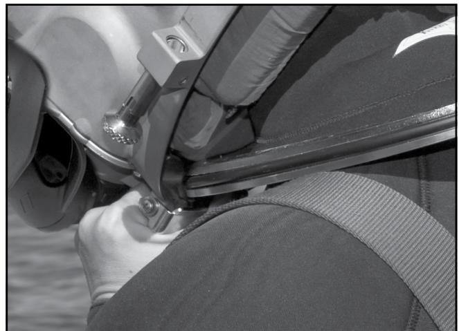
*Empuje el cuello de contención y el conjunto de anillos para que queden por dentro del anillo inferior de la base del casco.*
